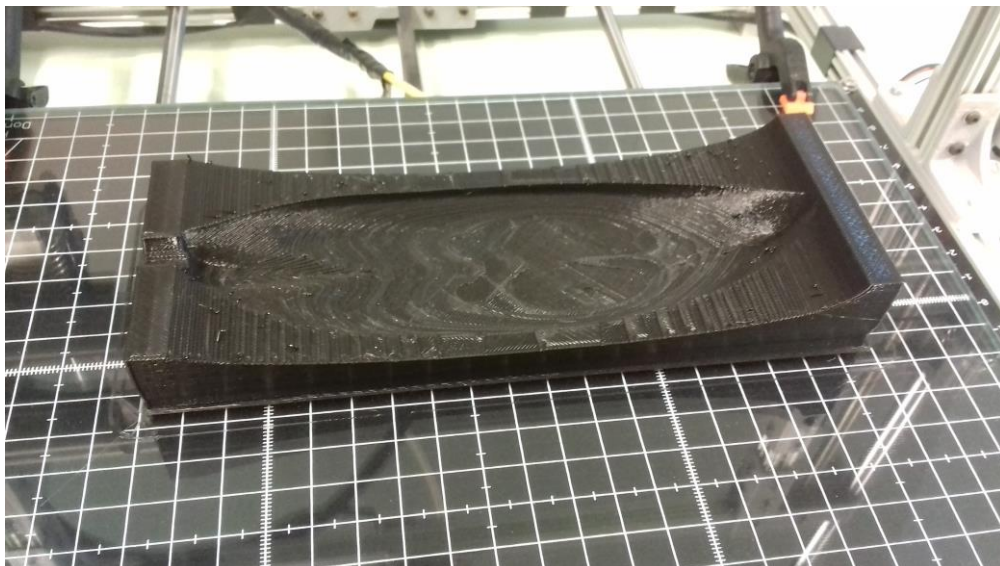
Slika 39. Gotovi model kalupa.
