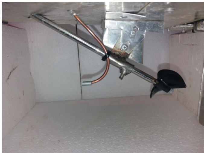
Slika 18. Vratilo i propeler.
