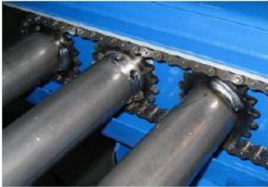
Slika 10. Prijenos vučne sile lancem
