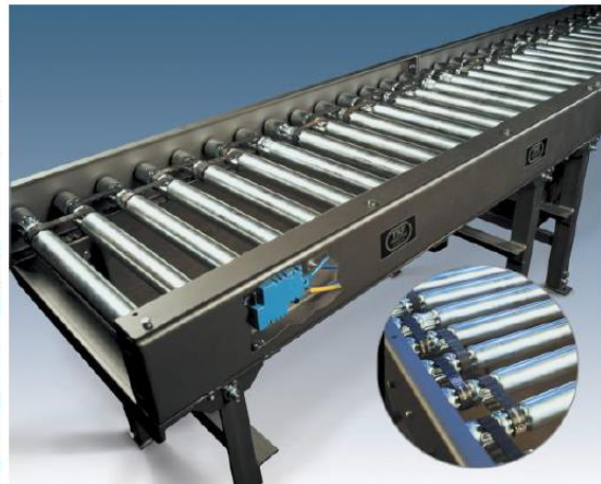
Slika 11. Prijenos vučne sile remenom
