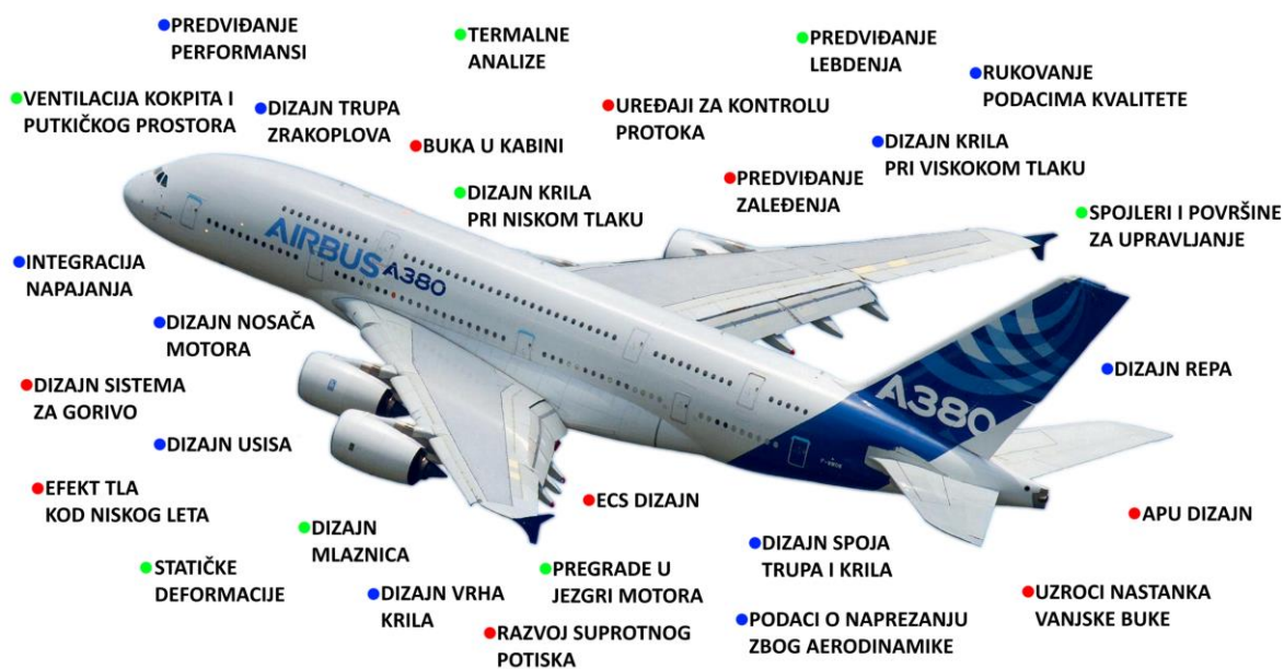
Slika 22. Doprinos CFD alata u razvoju zrakoplova Airbus A380
