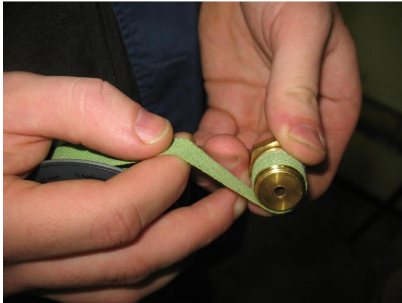
Slika 18. - Namatanje teflonske trake za brtvljenje na priključak
