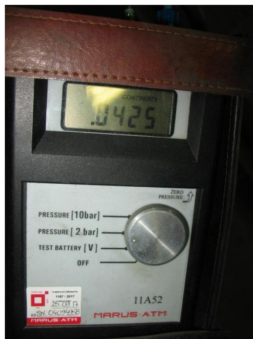
Slika 23. - Trenutna vrijednost tlaka u instalaciji
