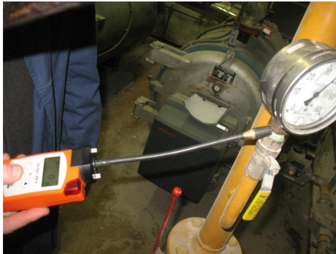
Slika 28. - Pregled spoja indikatorom plina
