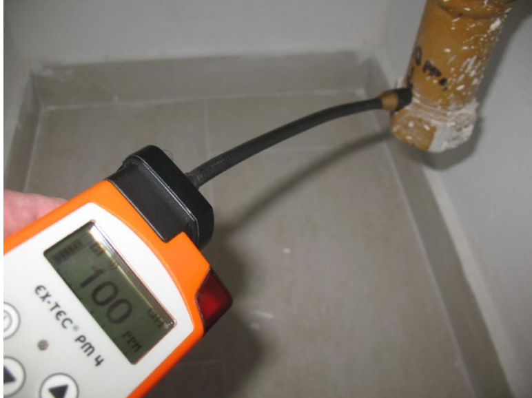
Slika 29. - Indikatorom plina pronađeno propuštanje
