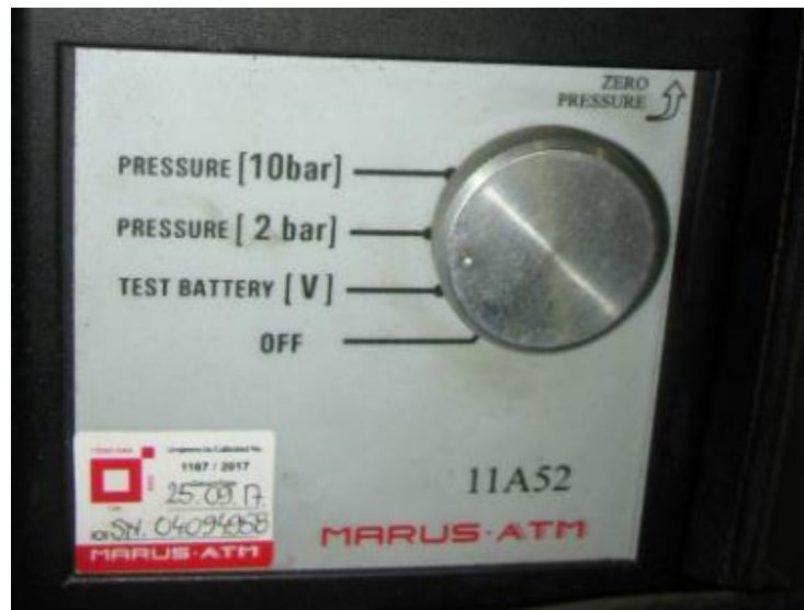
Slika 22. - Postavljanje na mjerno područje od 2 bar
