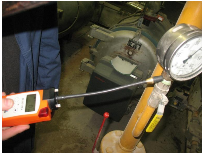
Slika 28. - Pregled spoja indikatorom plina
