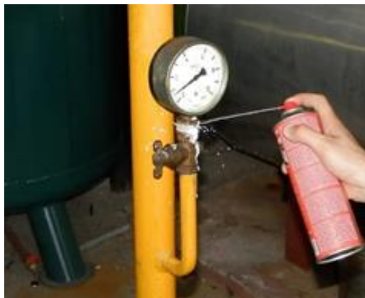
Slika 30. - Provjera spoja pjenušavim sredstvom
