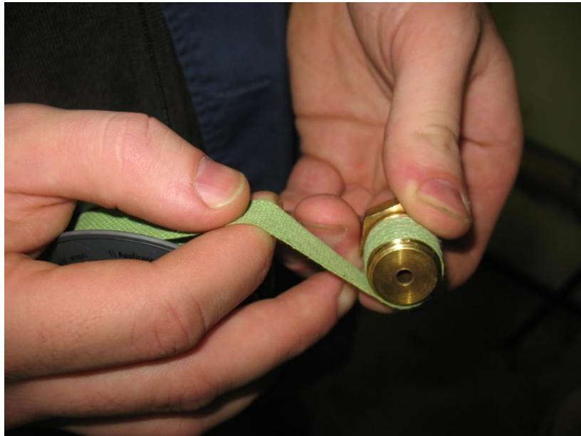
Slika 18. - Namatanje teflonske trake za brtvljenje na priključak
