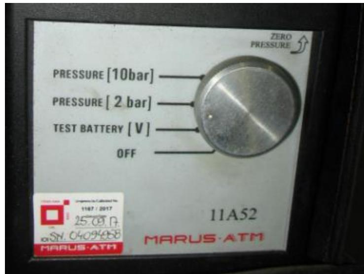
Slika 22. - Postavljanje na mjerno područje od 2 bar
