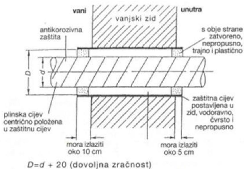
Slika 8. - Ulaz cjevovoda u kuću kroz zaštitnu čeličnu cijev
