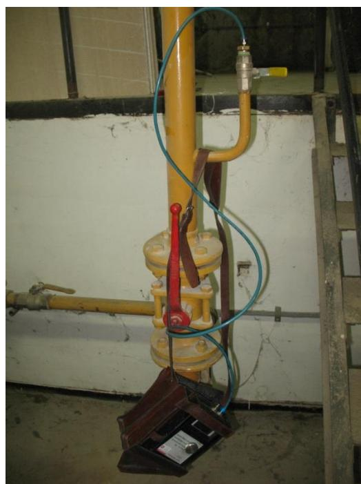
*Slika 21. - Digitalni mjerni uređaj spojen na instalaciju*
