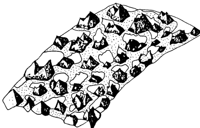
Slika 2.28: Struktura aktivne (rezne) površine brusa
