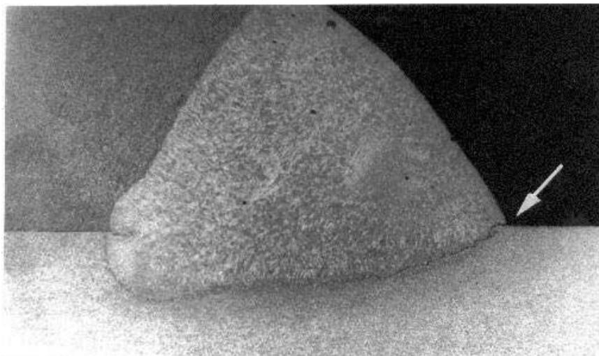
Slika 12. „Zarobljen“ oksidni sloj unutar zavara (1)
