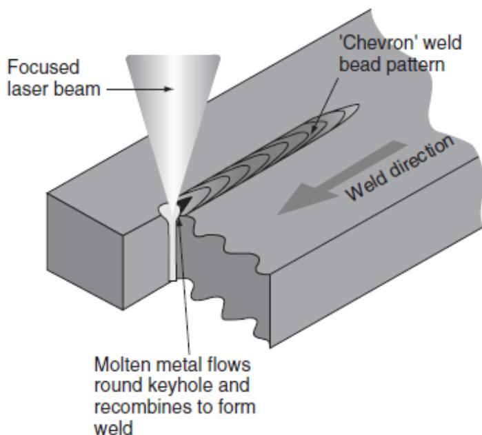
Slika 25., Princip laserskog zavarivanja (1)
