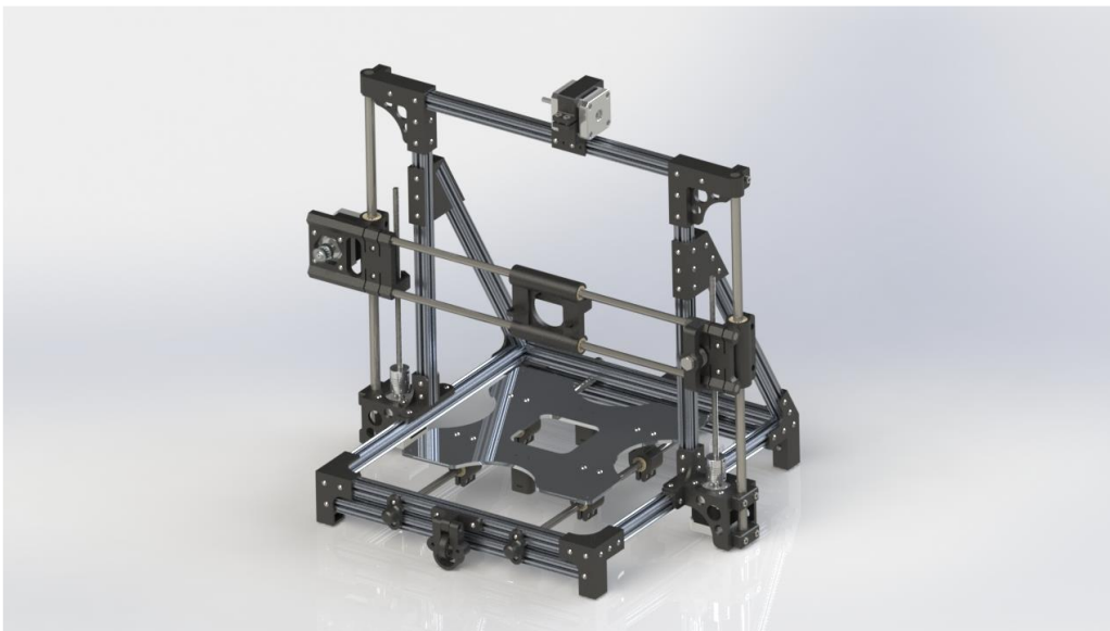
Slika 31. OpenBeam 3D printer. [28]
