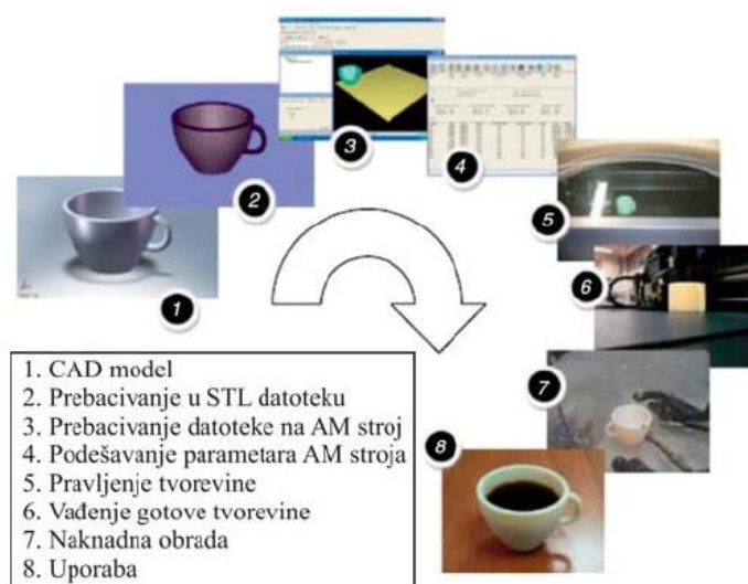
Slika 1. Faze aditivne proizvodnje. [1]
