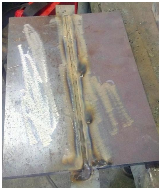
Slika 55. Gotov zavareni spoj, prije četkanja
