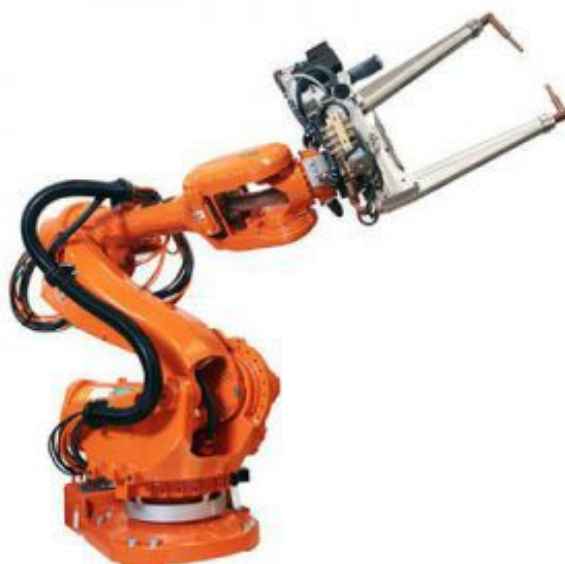
Slika 23. Robot za točkasto zavarivanje [28]
