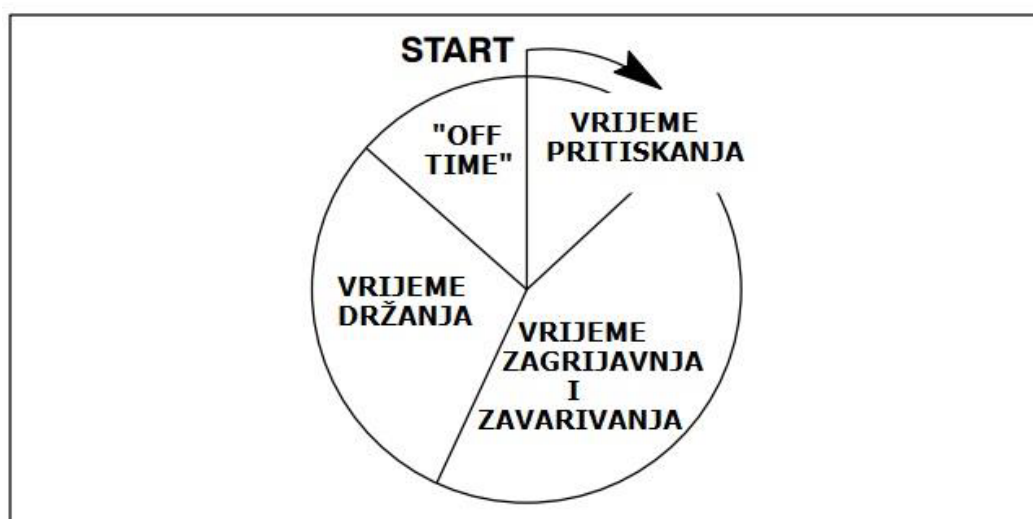
Slika 17. Vremenski ciklusi pri elektrootpornom zavarivanju [14]
