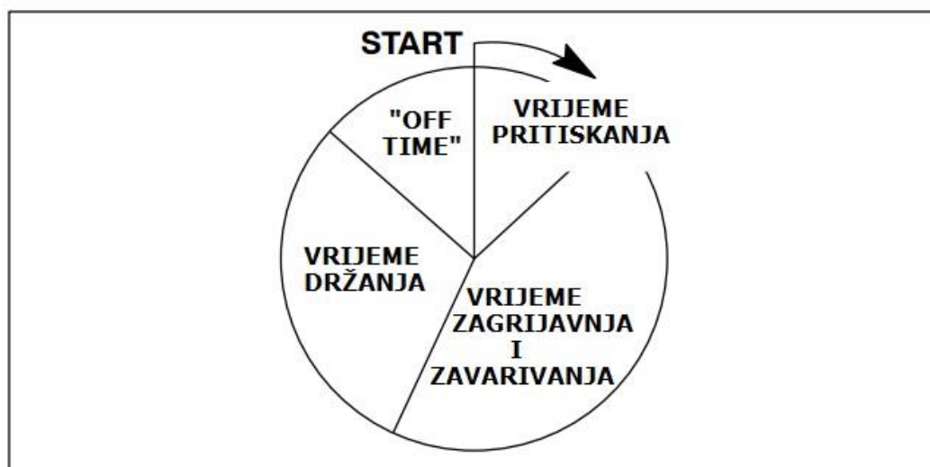
Slika 17. Vremenski ciklusi pri elektrootpornom zavarivanju [14]
