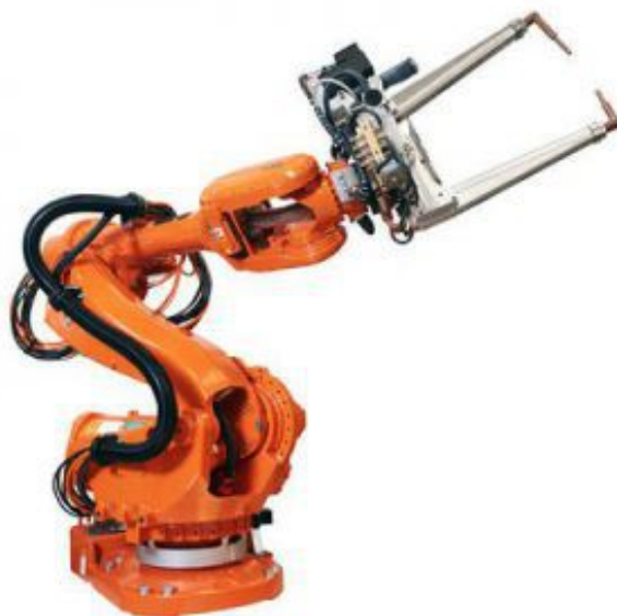
Slika 23. Robot za točkasto zavarivanje [28]
