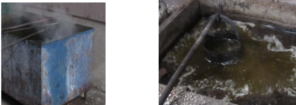
Slika 7.1.6. Gašenje u vodi i solnoj kupki.
