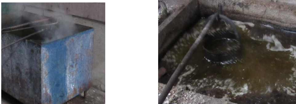
Slika 7.1.6. Gašenje u vodi i solnoj kupki.
