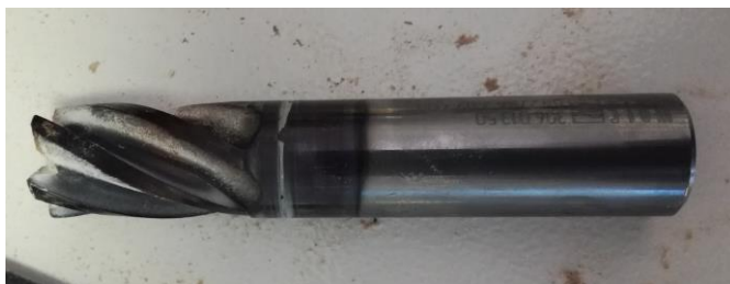
Slika 94. Tvrdometalno spiralno glodalo promjera 20mm
