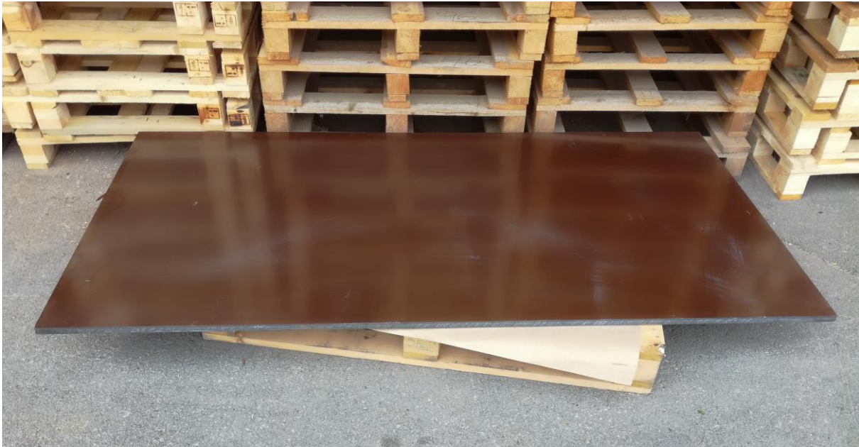
Slika 55. Sirova bakelitna ploča debljine 20mm dimenzije 2070x1070
