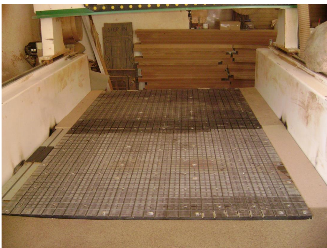
Slika 104. Završen vakuum stol spreman za korištenje
