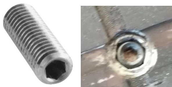
Slika 85. Uvrtni vijak M8x15 DIN815 i desno uvijen u vakuum stol
