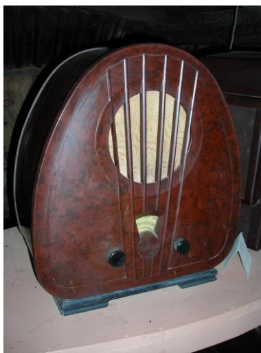
Slika 32. Stari radio s vanjskim bakelitnim kućištem
