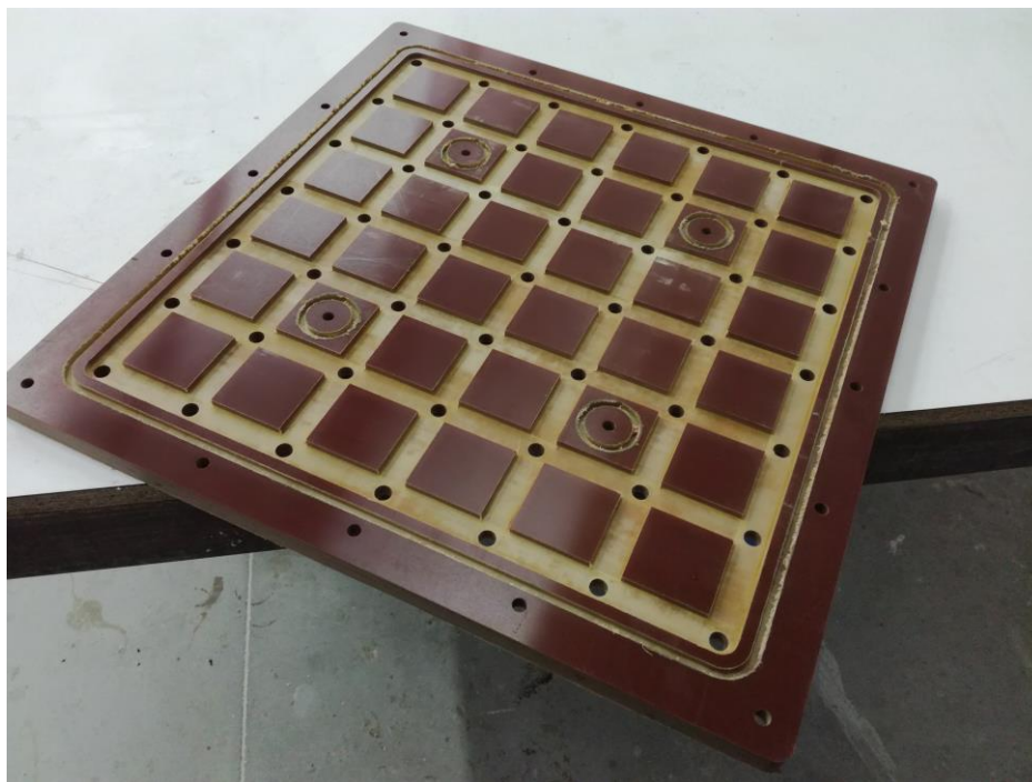
Slika 108. Unutarnja komora malog vakuum stola
