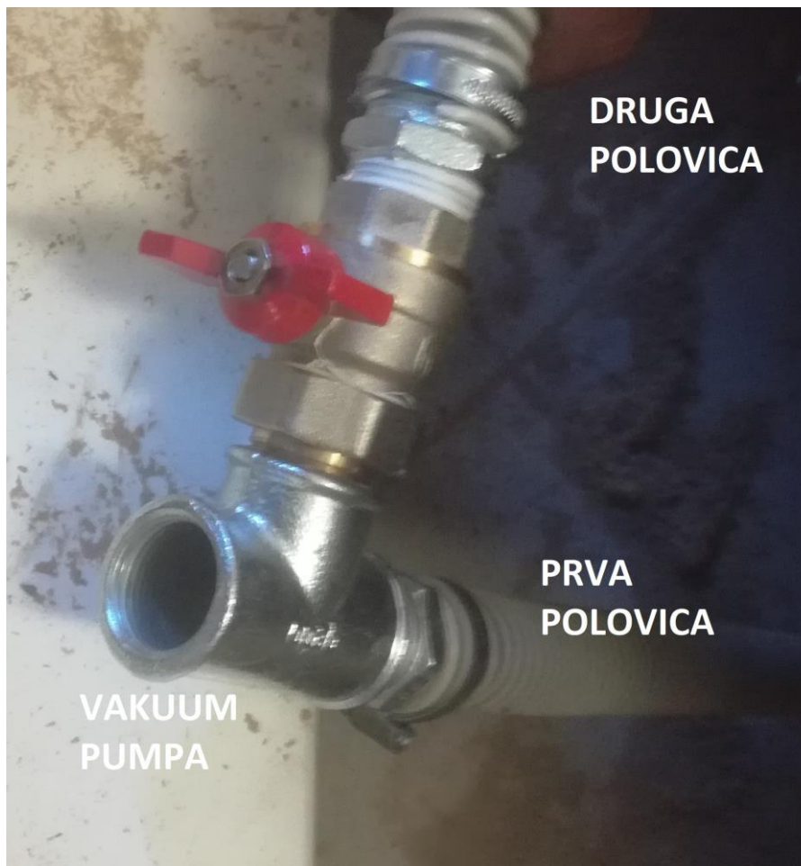
Slika 98. Ventil sa T-račvom
