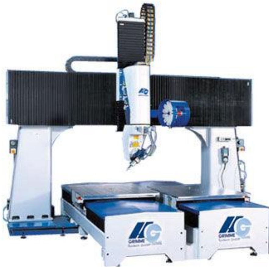
Slika 4. Huber & Grimme 5-osni CNC obradni centar
