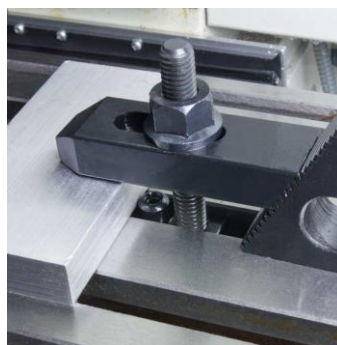
Slika 23. Obradak stegnut t-slot načinom korištenjem stupnjevite prizme
