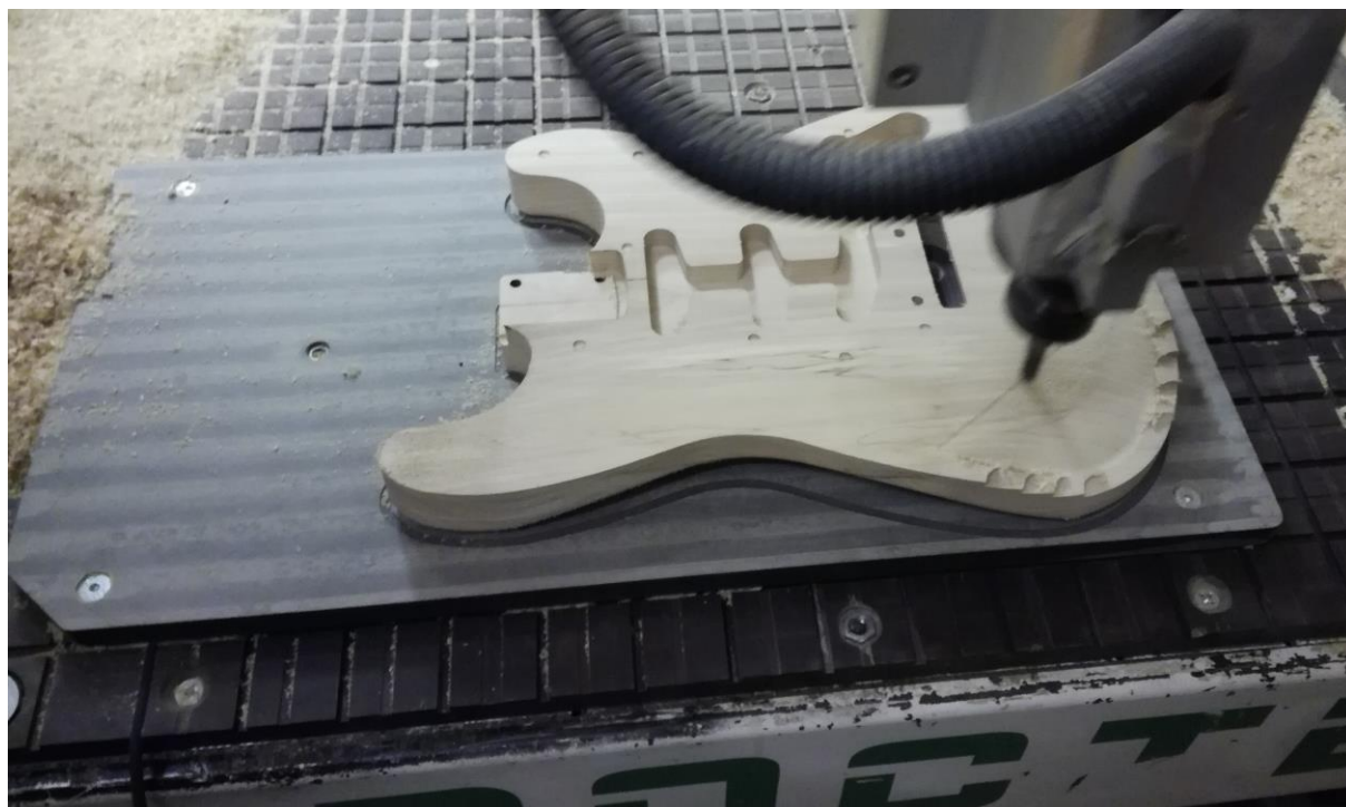
Slika 136. Glodanje druge strane tijela gitare
