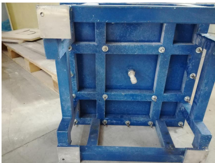
Slika 112. Donja strana (vidljive pakne i brza spojka)
