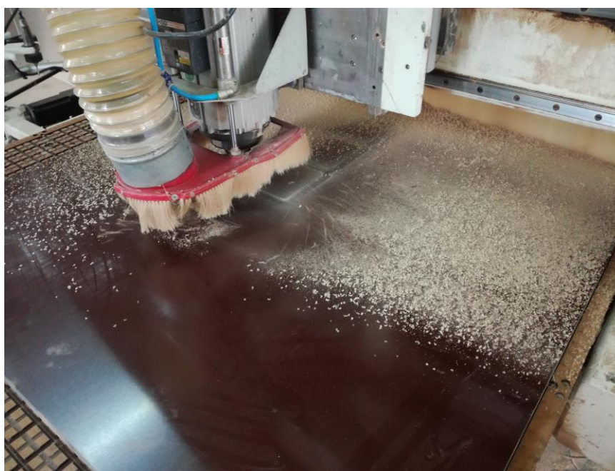
Slika 57. Početak glodanja komore
