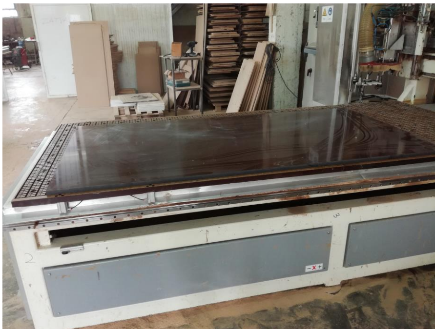
Slika 56. Bakelitna ploča na CNC-u Bulleri u Aquaestil plus d.o.o.
