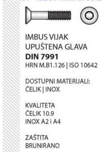
Slika 64. Tehnički podaci imbus vijka sa upuštenom glavom DIN 7991 [5]
