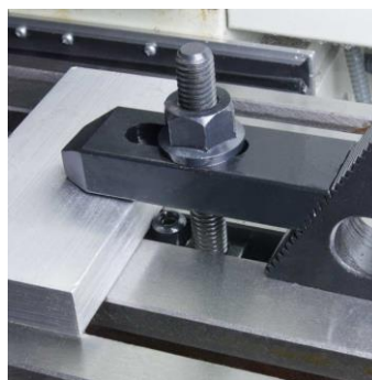
Slika 23. Obradak stegnut t-slot načinom korištenjem stupnjevite prizme
