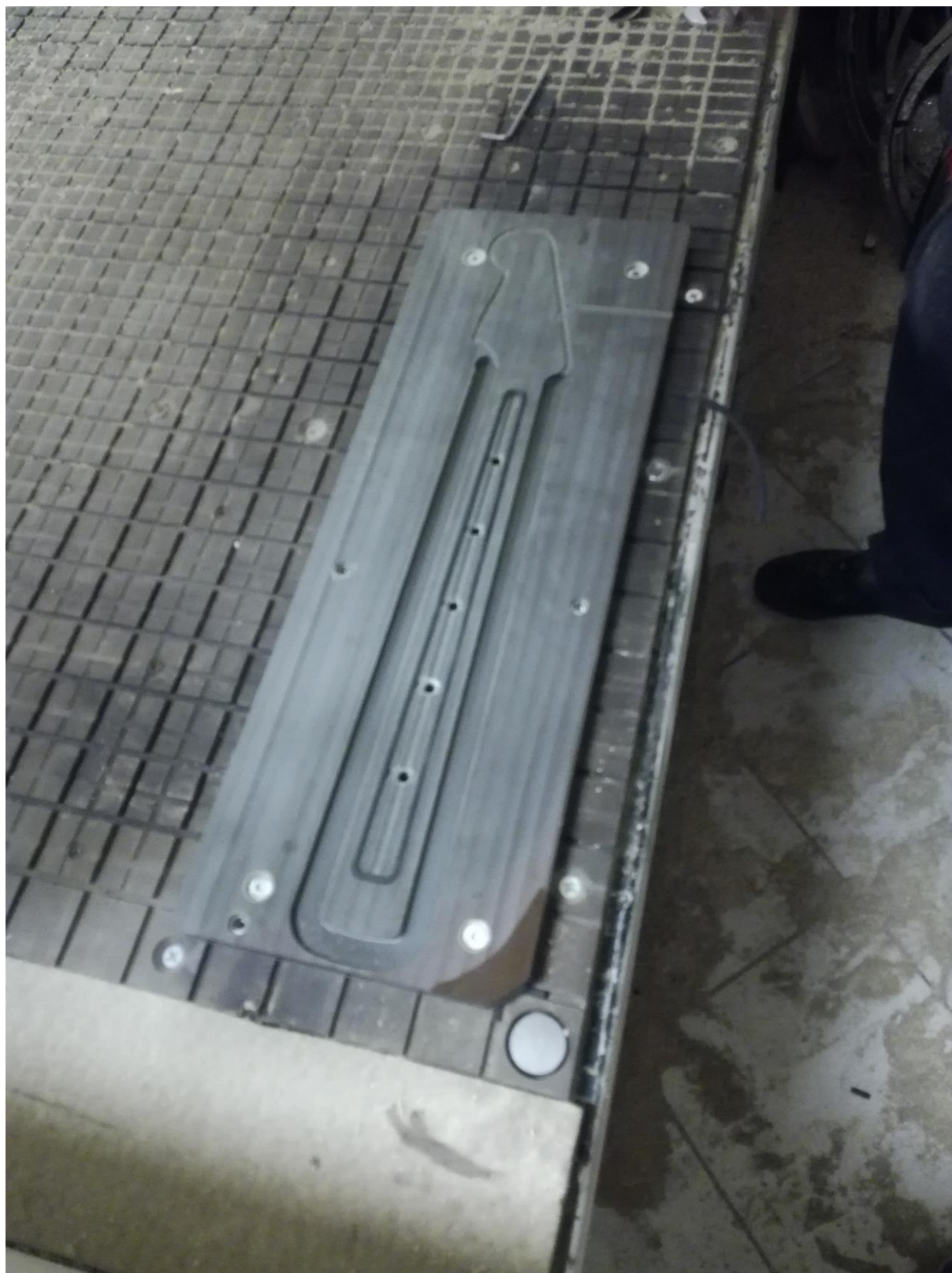
Slika 134. Gotova šablona za vrat gitare
