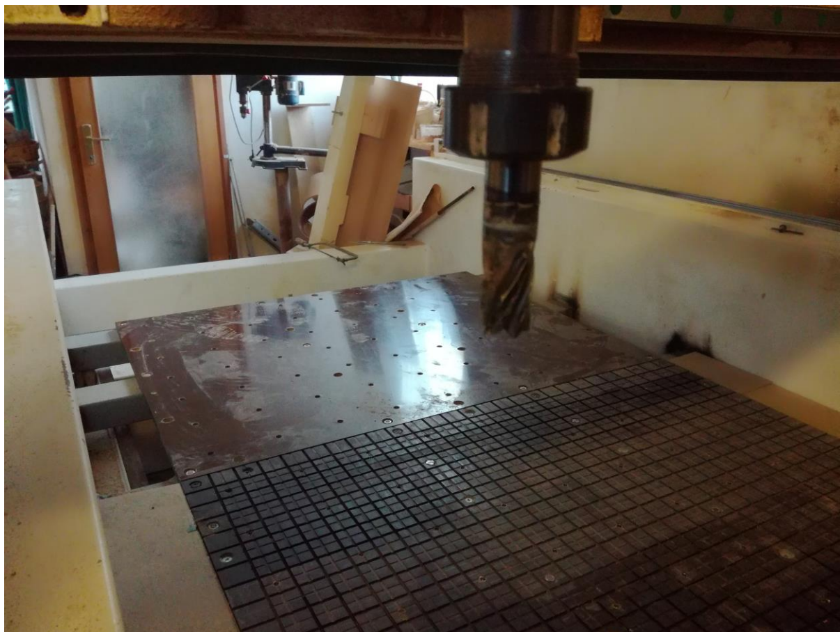
Slika 93. Druga polovica vakuum stola u konačnoj poziciji
