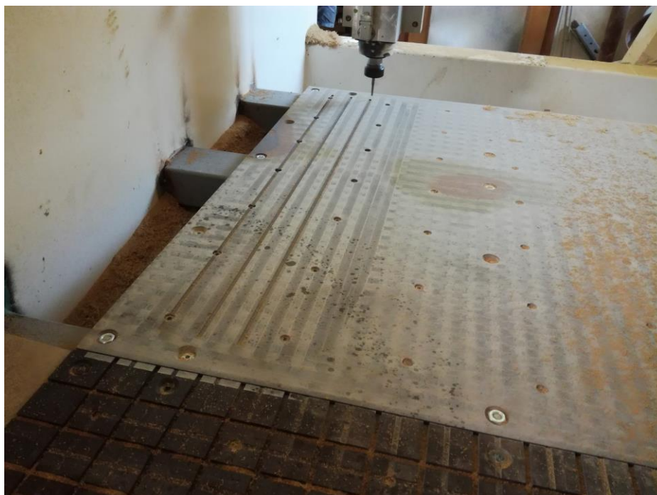
Slika 103. Urezivanje kanala u drugu polovicu vakuum stola
