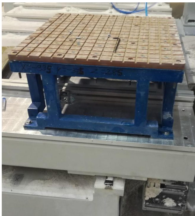
Slika 114. Prijenosni vakuum stol u poziciji za rad
