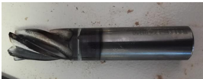
Slika 94. Tvrdometalno spiralno glodalo promjera 20mm
