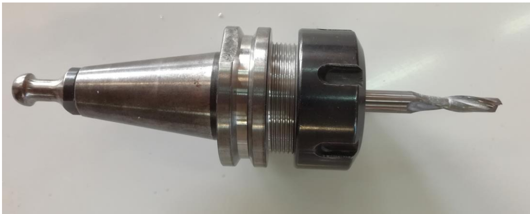
Slika 49. Spiralno dvoperno glodalo promjera 6mm
