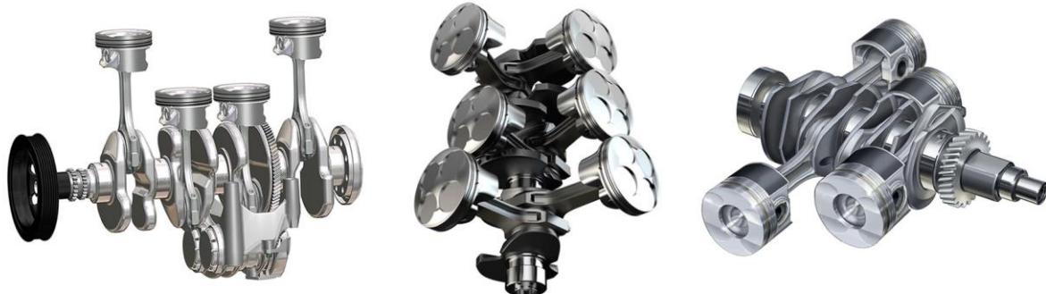
Slika 05. Konfiguracije motora – redni, V i nasuprotni-bokser [12]
