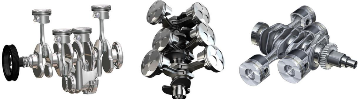
Slika 05. Konfiguracije motora – redni, V i nasuprotni-bokser [12]
