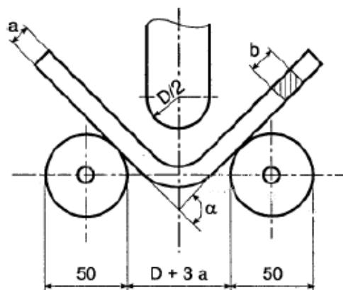
Slika 49. Shematski prikaz uređaja za ispitivanje savijanjem [24]
