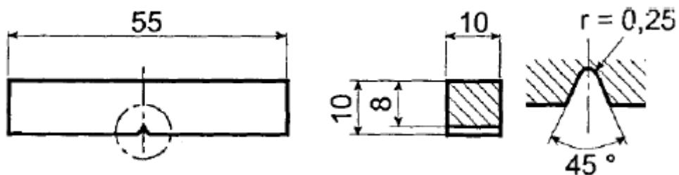
**Slika 59. Dimenzije epruvete za ispitivanje udarnog rada loma [24]**
