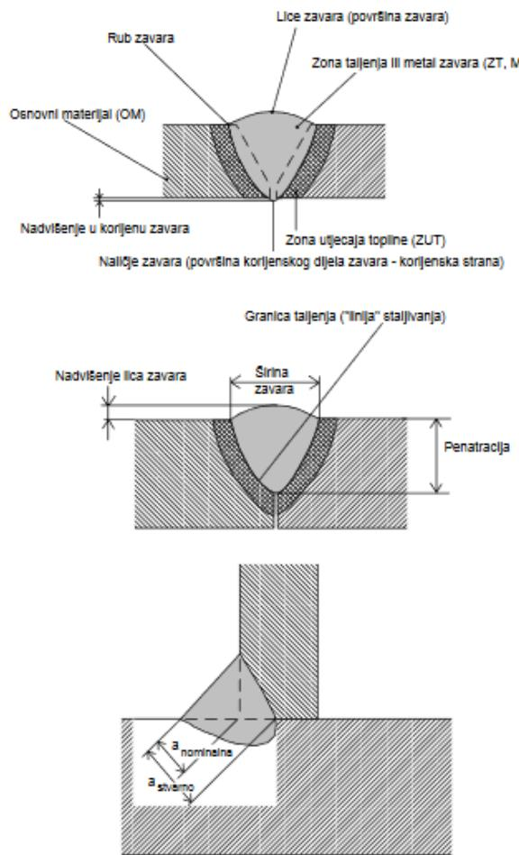
**Slika 13. Elementi spoja zavarenog taljenjem [12]**
