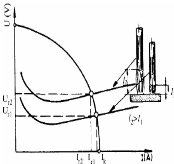
**Slika 10. Promjena radne točke kod strmopadajuće karakteristike [6]**
