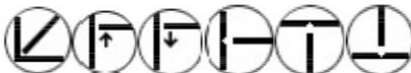
Slika 34. Položaji zavarivanja celuloznom elektrodom [20]
