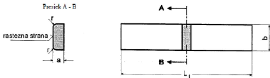
Slika 48. Epruveta za ispitivanje savijanjem [24]
