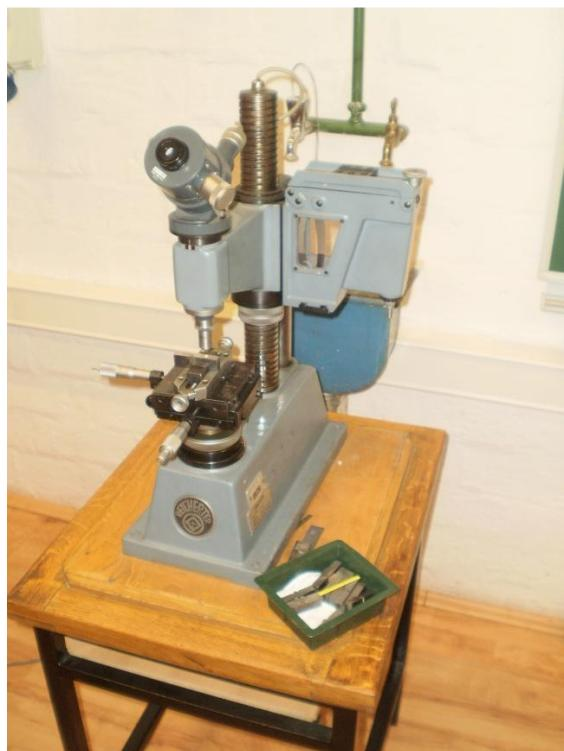
**Slika 62. Predodžba tvrdomjera Reicherter TM12 [28]**
