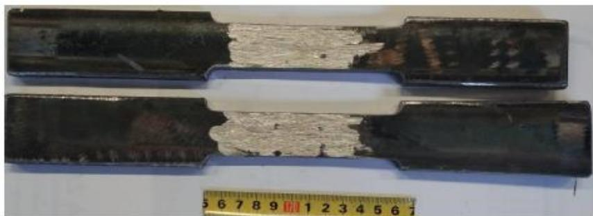
Slika 46. Predodžba epruvete za statički vlačni pokus [5]
