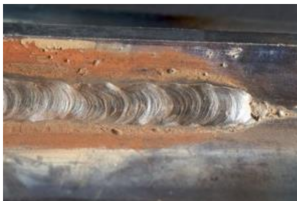
Slika 24. Prespora brzina zavarivanja [2]
