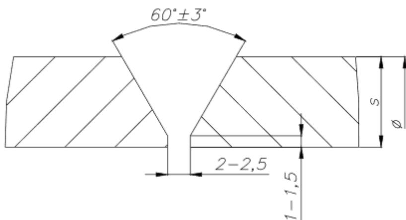
**Slika 36.** Izgled pripreme žljeba za zavarivanje [21]
