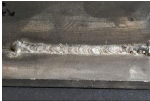
Slika 25. Prevelika brzina zavarivanja [2]
