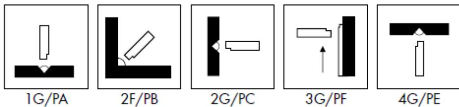
Slika 33. Položaji zavarivanja bazičnom elektrodom [19]
