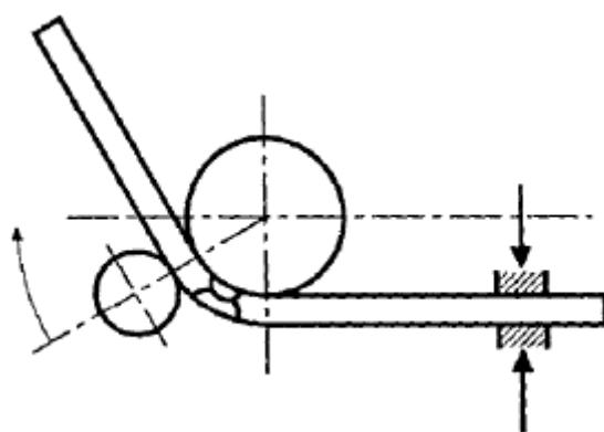
**Slika 51.** Naprava za bočno ispitivanje savijanjem [24]
