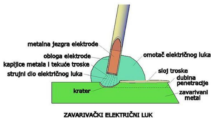
Slika 3. Zavarivački električni luk [1]
