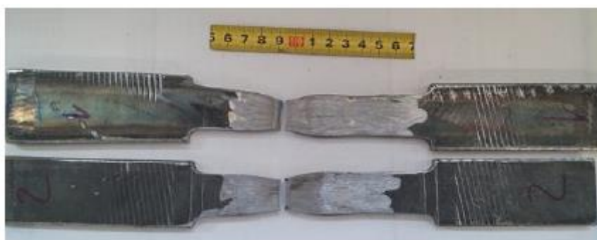
Slika 47. Predodžba epruvete nakon statičkog vlačnog pokusa [5]
