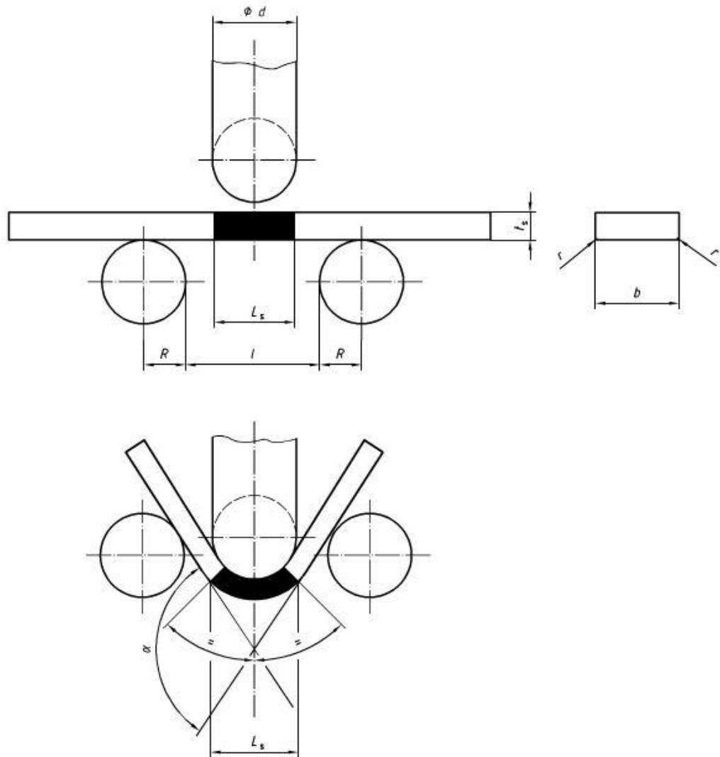
Slika 52. Shema izvođenja ispitivanja zavarenog spoja na savijanje [26]
