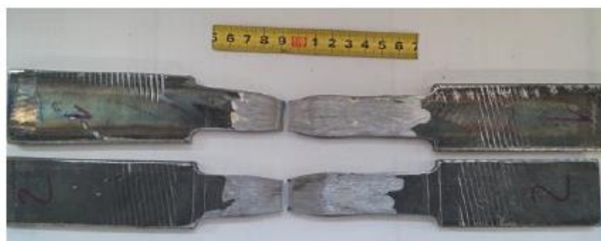
Slika 47. Predodžba epruvete nakon statičkog vlačnog pokusa [5]
