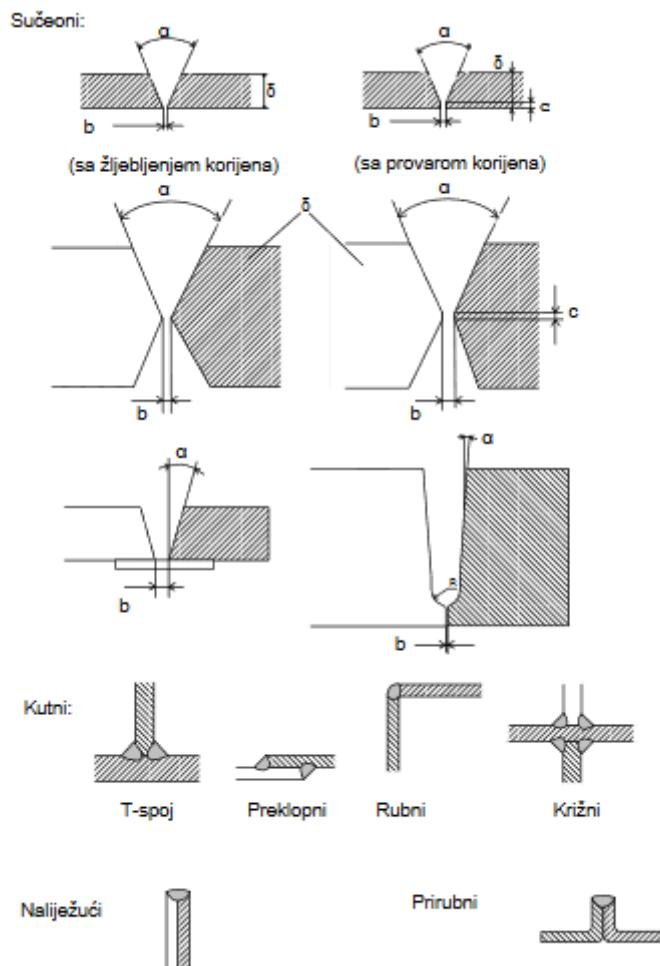
Slika 12. Primjeri spojeva i žljebova za zavarivanje [12]
