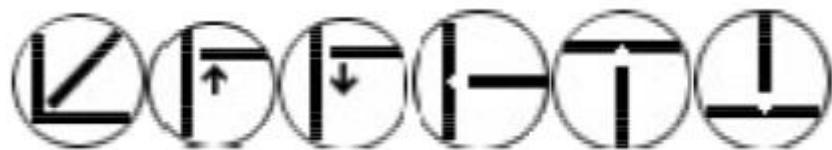
Slika 34. Položaji zavarivanja celuloznom elektrodom [20]
