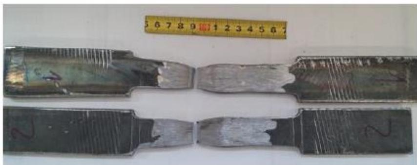
Slika 47. Predodžba epruvete nakon statičkog vlačnog pokusa [5]
