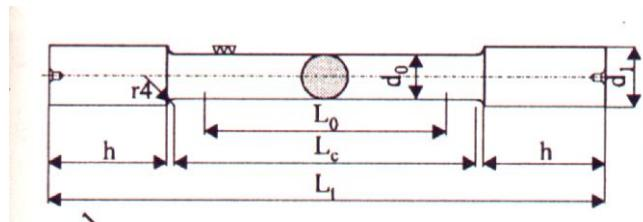
Slika 42. Epruveta za statički vlačni pokus [23]
