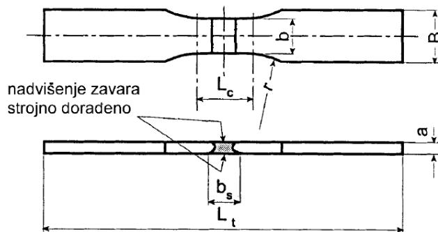
Slika 43. Plosna epruveta [24]
