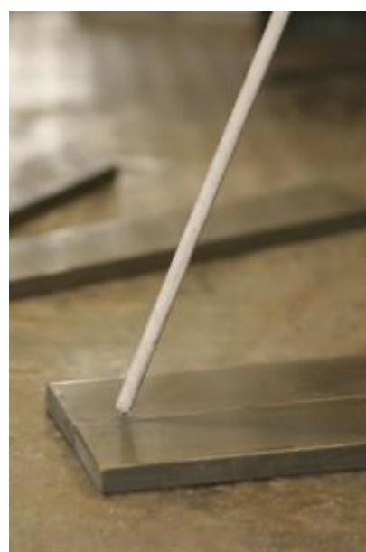
Slika 22. Kut elektrode - kod zavarivanja s lijeva na desno treba držati elektrodu od  $0-15^{\circ}$  u odnosu na pravac kretanja - backhand tehnika [2]
