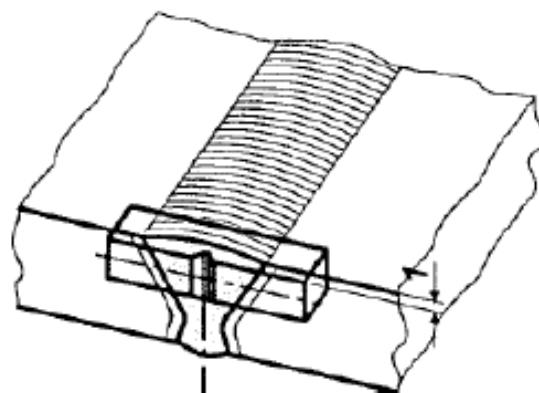
Slika 56. Predodžba epruvete za ispitivanje udarnog rada loma [24]
