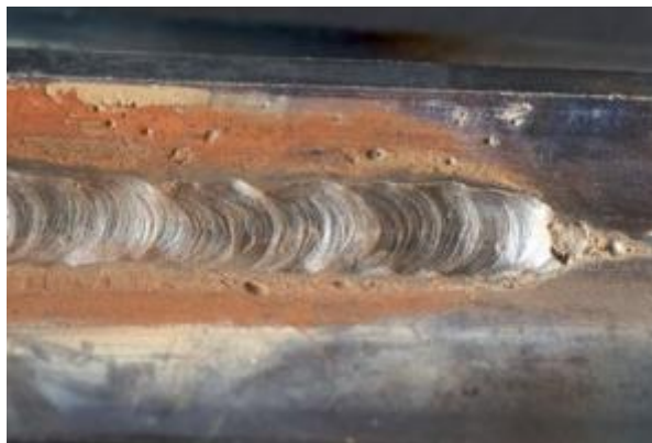
Slika 24. Prespora brzina zavarivanja [2]
