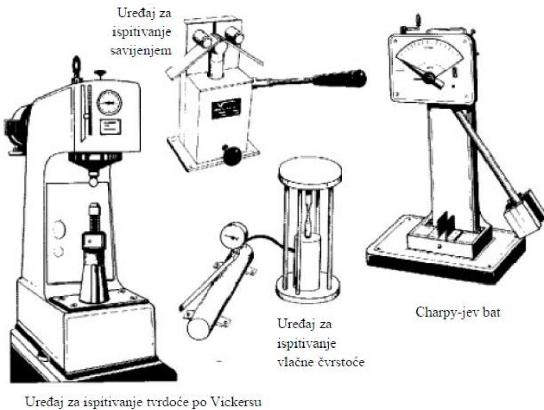
**Slika 41. Uredaji za ispitivanje zavarenih spojeva [24]**
