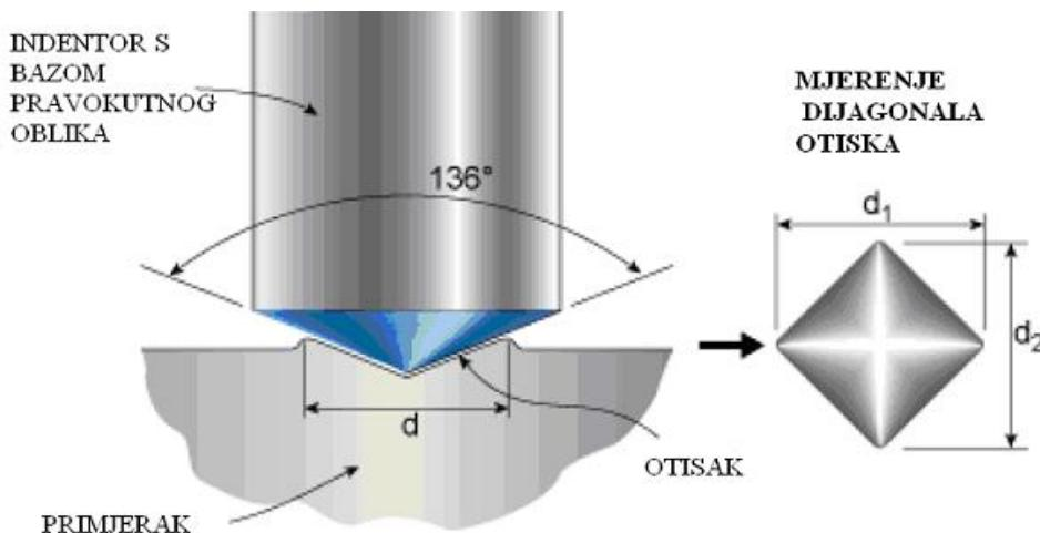
**Slika 61. Shematski prikaz ispitivanja tvrdoće Vickersovom metodom [24]**
