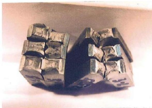
Slika 60. Epruvete udarne radnje loma nakon ispitivanja [29]
