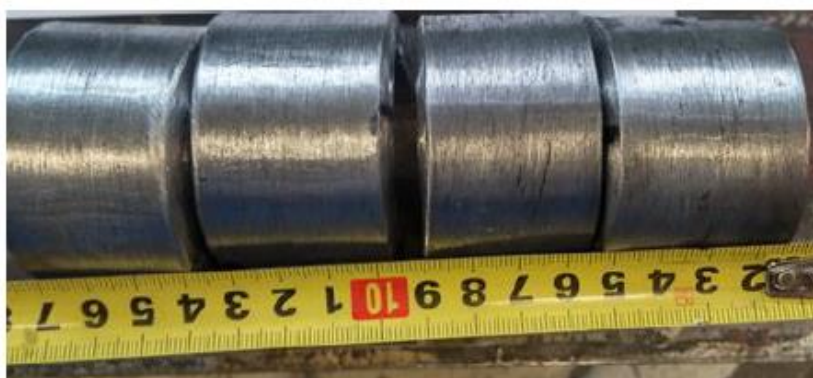
Slika 55. Predodžba rezultata ispitivanja savijanjem [26]
