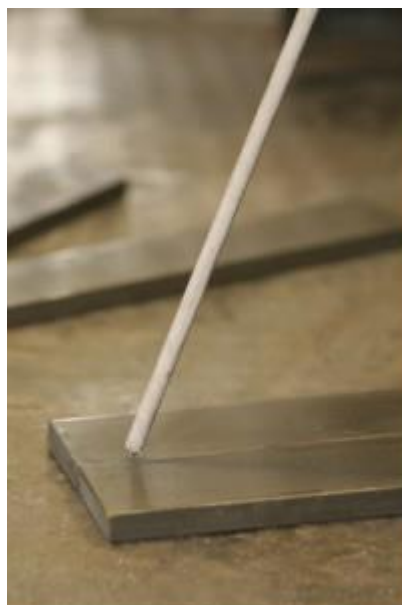
Slika 22. Kut elektrode - kod zavarivanja s lijeva na desno treba držati elektrodu od 0-15 ° u odnosu na pravac kretanja - backhand tehnika [2]
