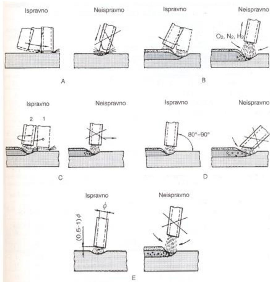
Slika 15. Prikaz tehnikе rada kod REL zavarivanja [6]
