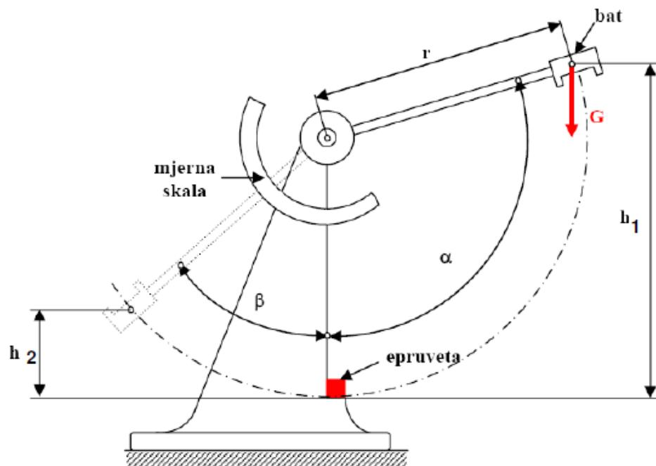
Slika 58. Shematski prikaz ispitivanja po Charpyu [27]
