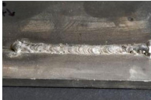
**Slika 25.** Prevelika brzina zavarivanja [2]
