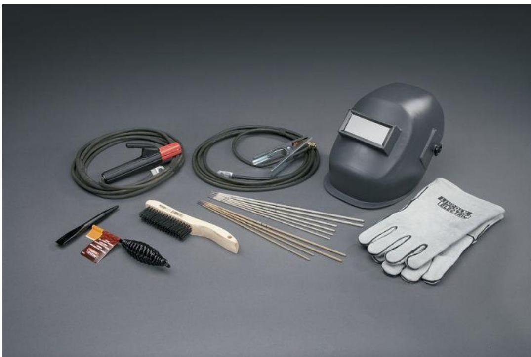
Slika 9. Oprema za REL zavarivanje [1]
