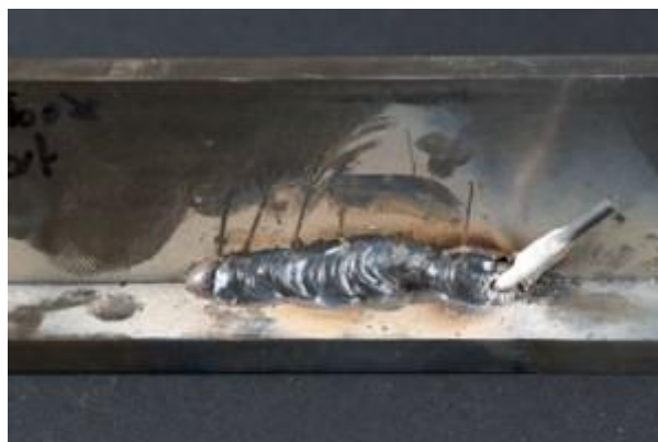
Slika 20. Kratka duljina električnog luka [2]
