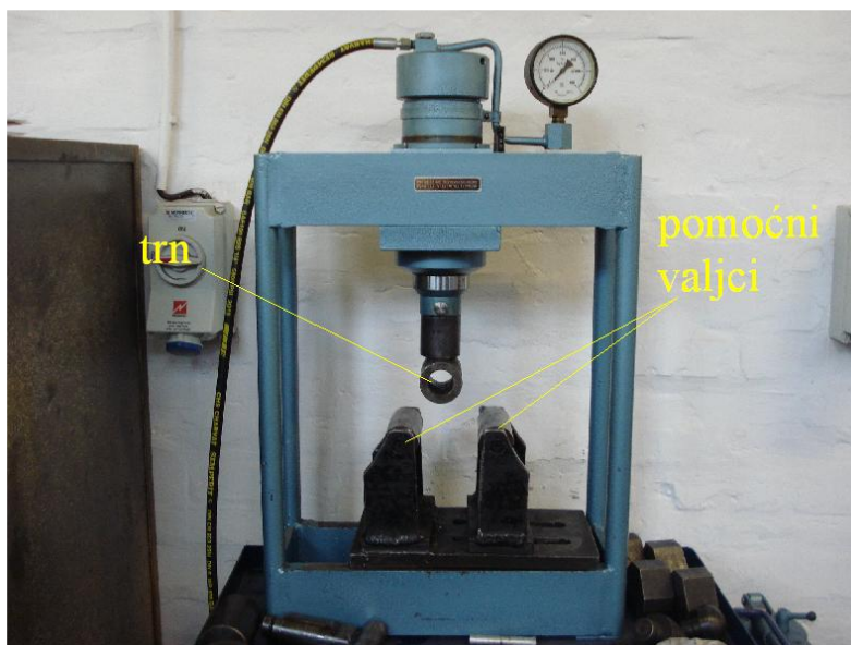
Slika 53. Predodžba naprave za ispitivanje zavarenih spojeva na savijanje [26]
