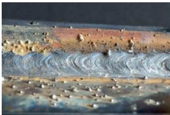
Slika 21. Prevelika duljina električnog luka [2]
