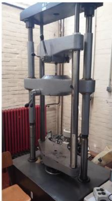
Slika 45. Predodžba kidalice WPM EU40mod [5]
