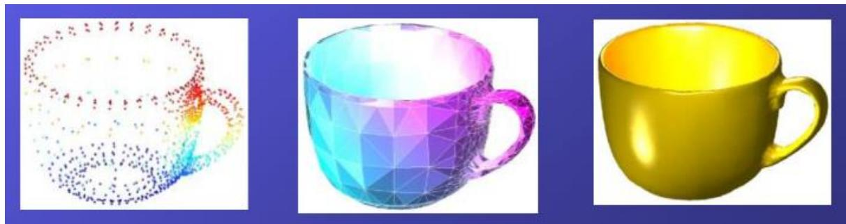
**Slika 10. Poligonalni prikaz u izradi CAD modela**
