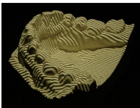
Slika 23. Projekcija linija na odljevak putem 3D digitalizacije SCANNER S600 ARTI
