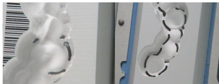
Slika 27. Grubo glodanje i fino glodanje
