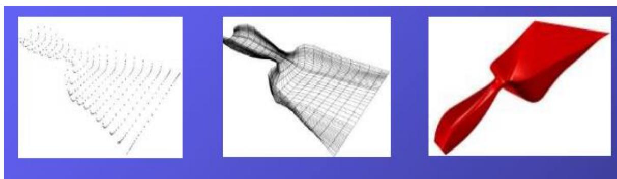
Slika 9. Prikaz poprečnih presjeka u izradi CAD model
