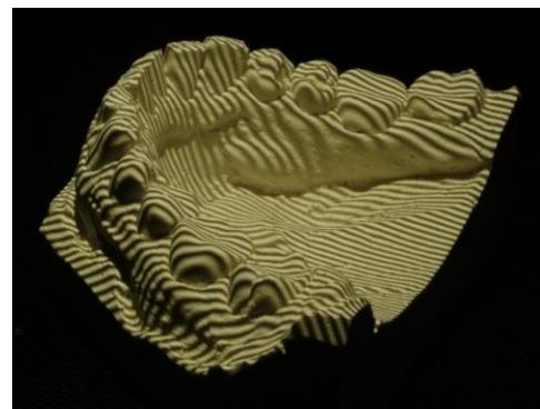
**Slika 23. Projekcija linija na odljevak putem 3D digitalizacije SCANNER S600 ARTI**
