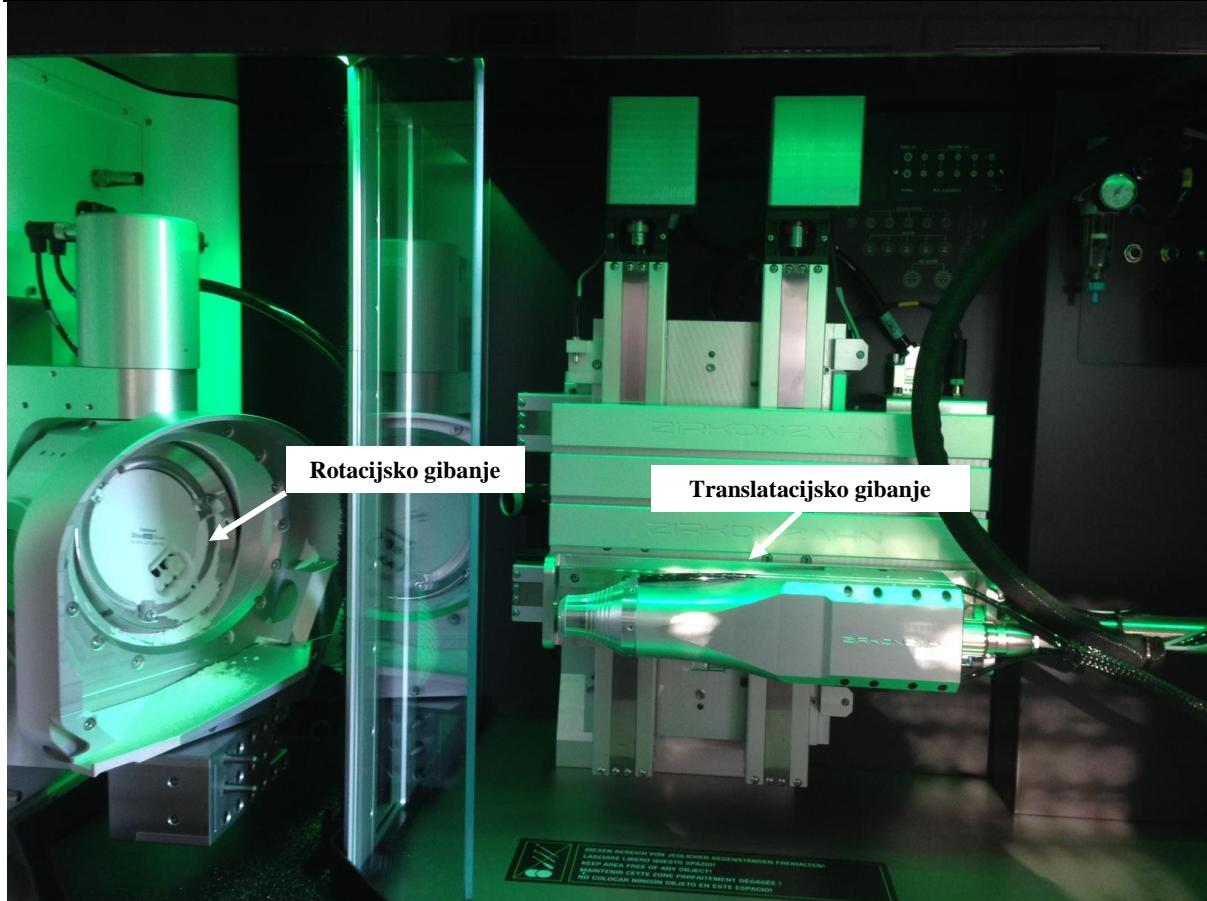
Slika 26. Glodalica M5
