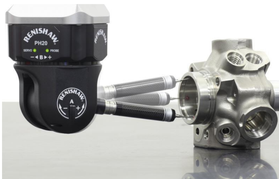
Slika 3. Mjerna glava Renishaw PH20 sa ticalom
