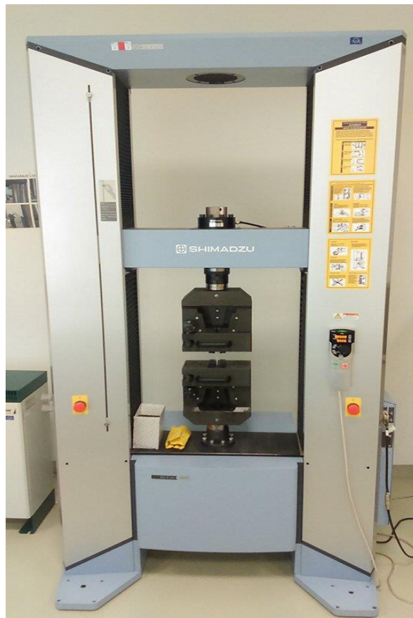
Slika 50. Kidalica Shimadzu AG-X plus za ispitivanje mehaničkih svojstava materijala
