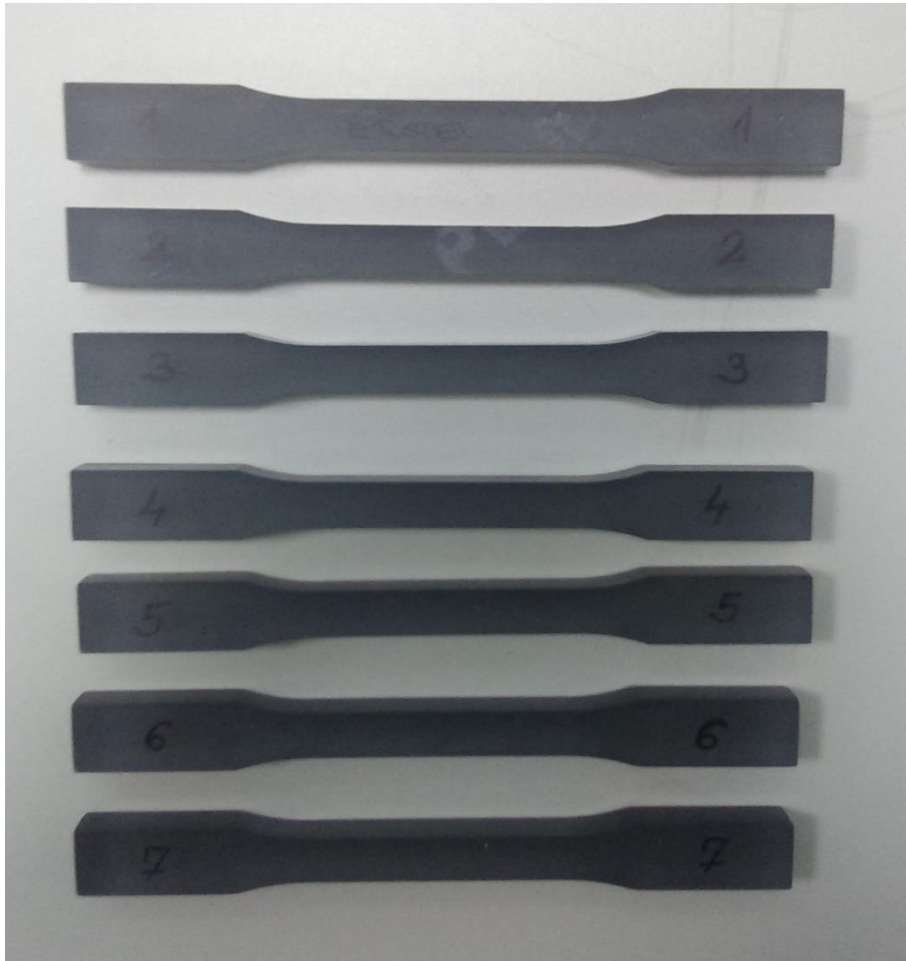
Slika 63. Epruvete Perspex poli(metil-metakrilata) na kojima se vršilo ispitivanje statičkog vlačnog pokusa
