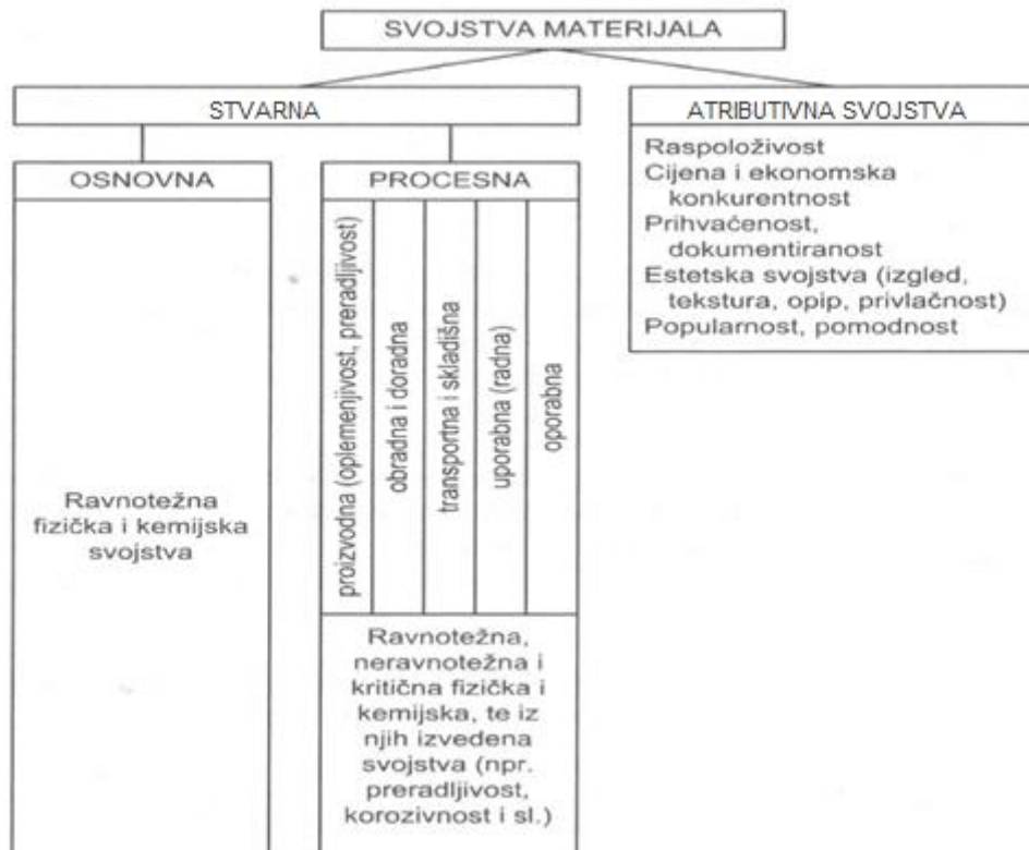
Slika 11. Sistematizacija svojstava polimernih materijala [1]
