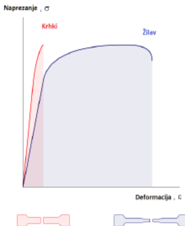
Slika 20. Prikaz krivulje "naprezanje - deformacija", krhkog i žilavog materijala [8]
