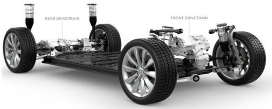
Slika 20. Podvozje Modela S sa svim komponentama[3]
