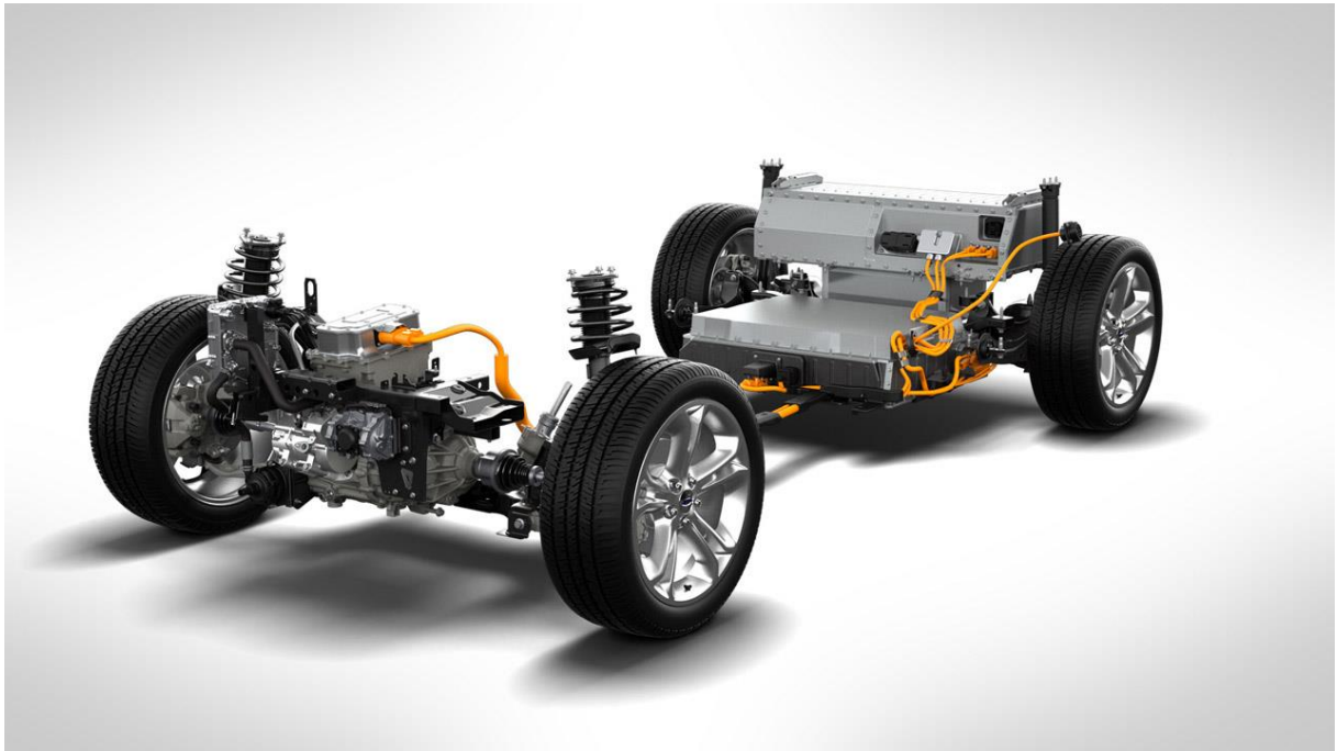
Slika 22. Podvozje automobila Ford Focus Electric [3]
