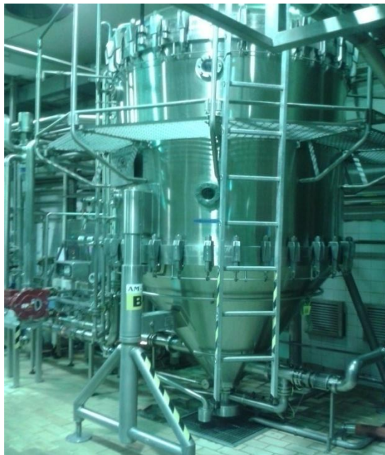
Slika 1. Kieselguhr filter (Autor: Boris Đurić)
