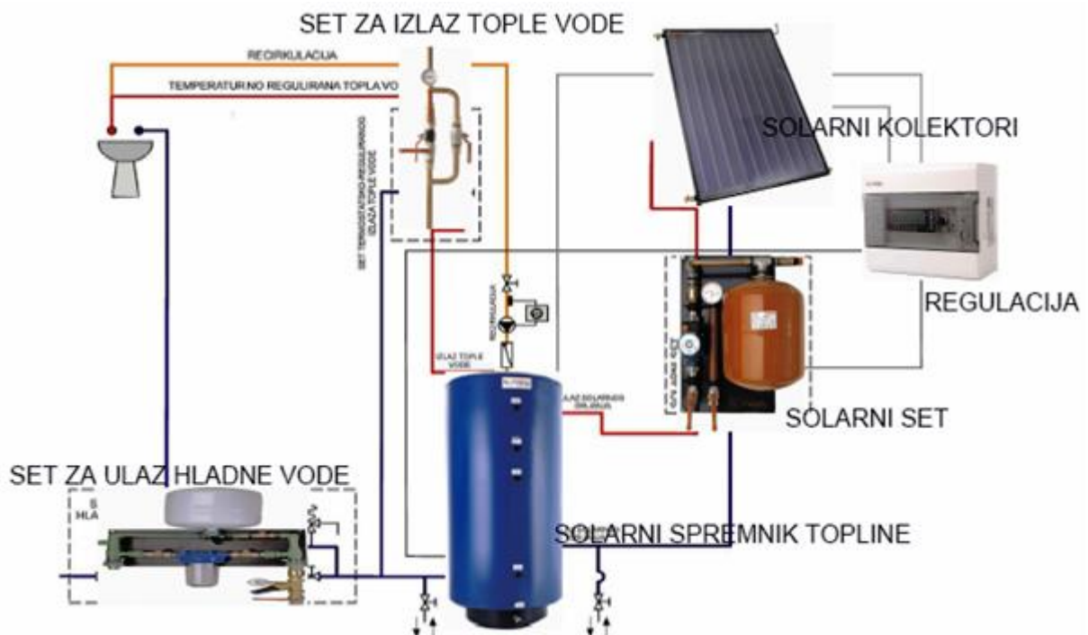
Slika 2. 4. Solarni sustav za pripremu PTV-a
