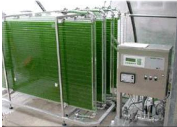
Slika 9. Uzgoj algi u zatvorenim sustavima (fotobioreaktori)
