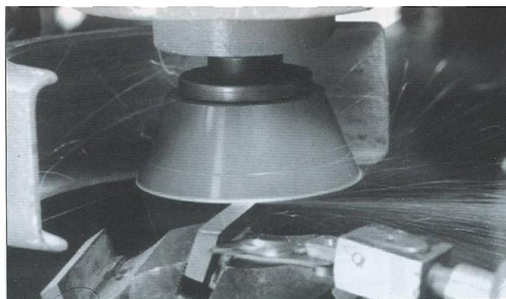
*Slika 33 Oštrenje noža iz tvrdog metala s dijamantnim brusom*
