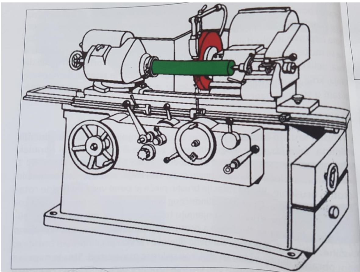
Slika 30 Shema brusilice za uzdužno vanjsko kružno brušenje
