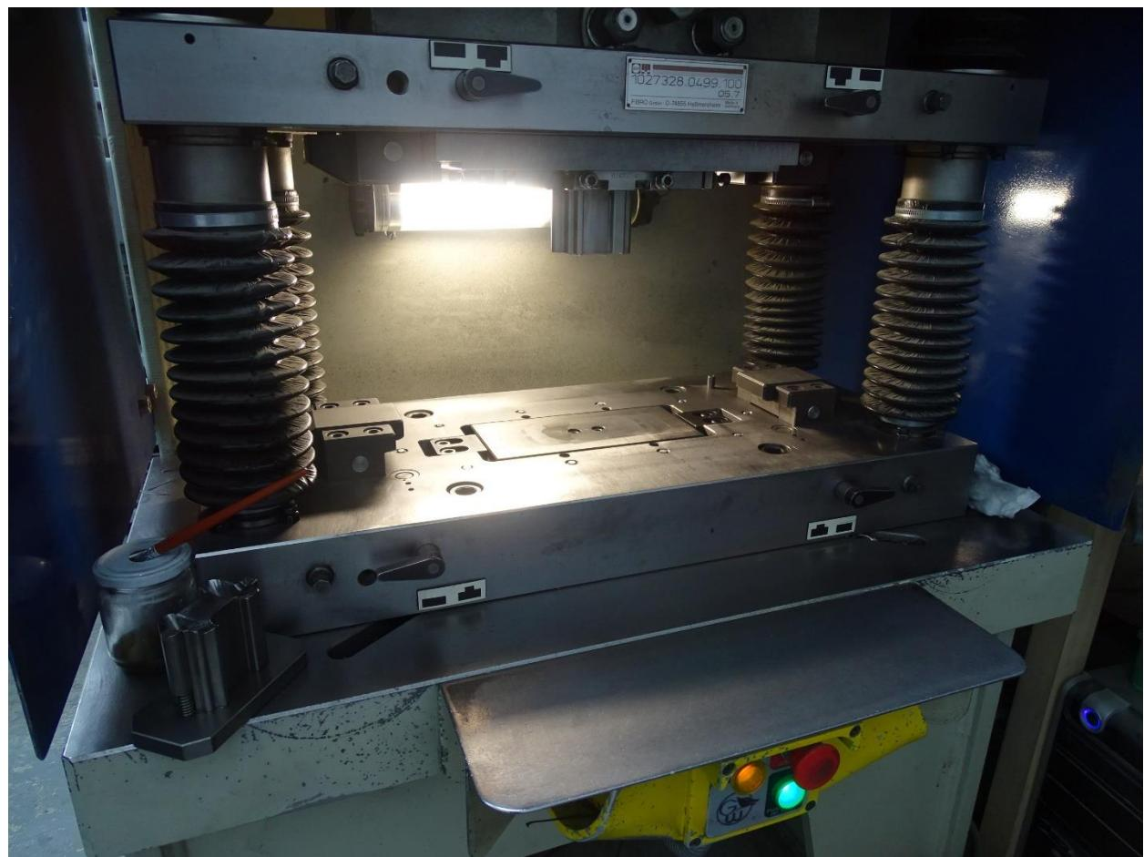
Slika 8 Presa za precizno odsijecanje bridova sa zaštitom dvoručnog upravljanja, te laserskim senzorom za upravljanje zaštitnim stakлом
