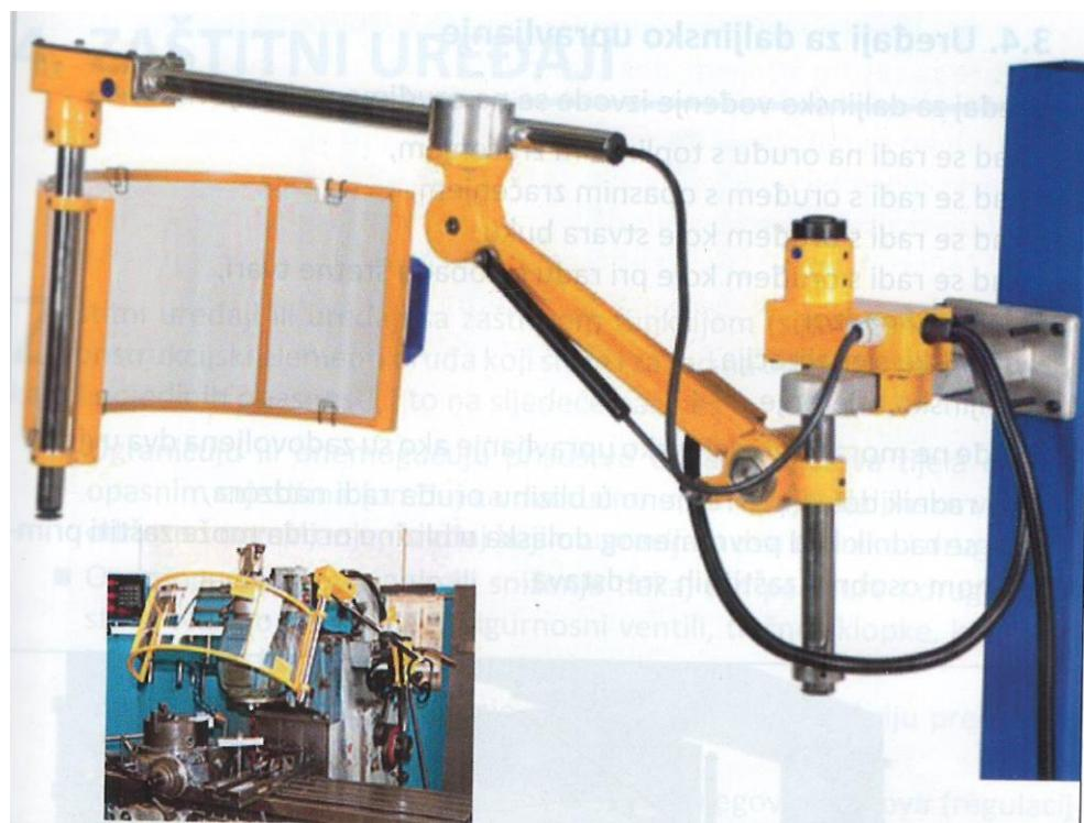
Slika 3 Automatska zaštitna naprava
