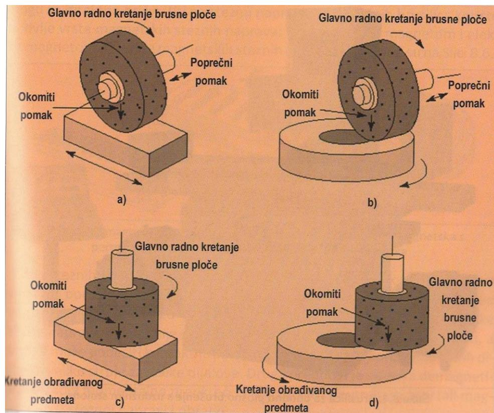
Slika 24 Vrste plošnog brušenja: a) obodno plošno brušenje na uzdužnom stolu, b) na okretnom stolu, c) čeono plošno brušenje na uzdužnom stolu, d) na okretnom stolu
