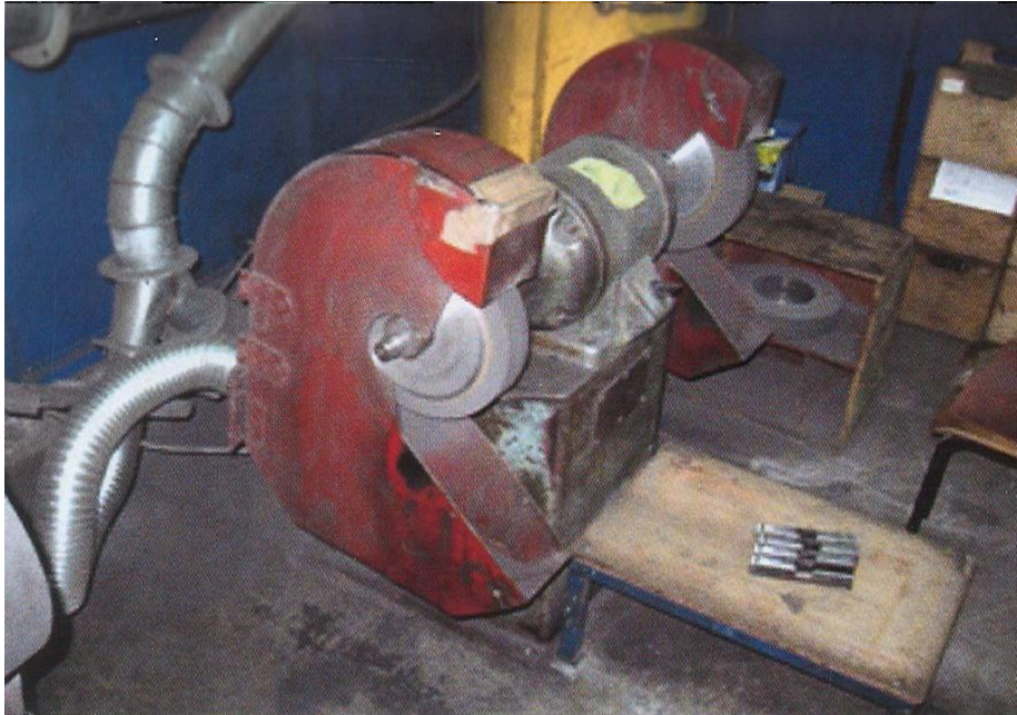
Slika 44 Stupna radionička brusilica nakon višegodišnje uporabe
