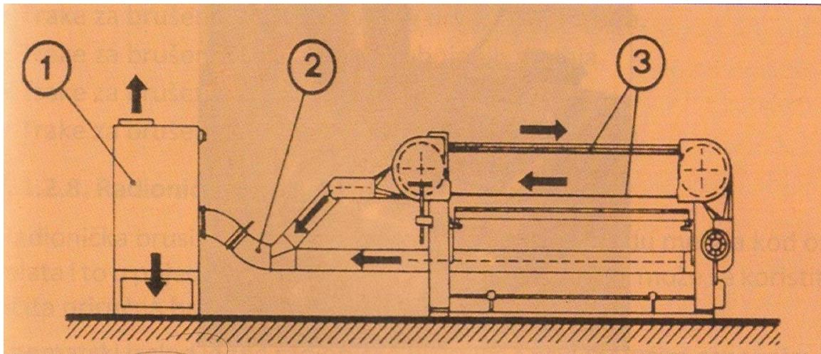
Slika 39 Samostalni uređaj za oprašivanje na tračnoj brusilici
