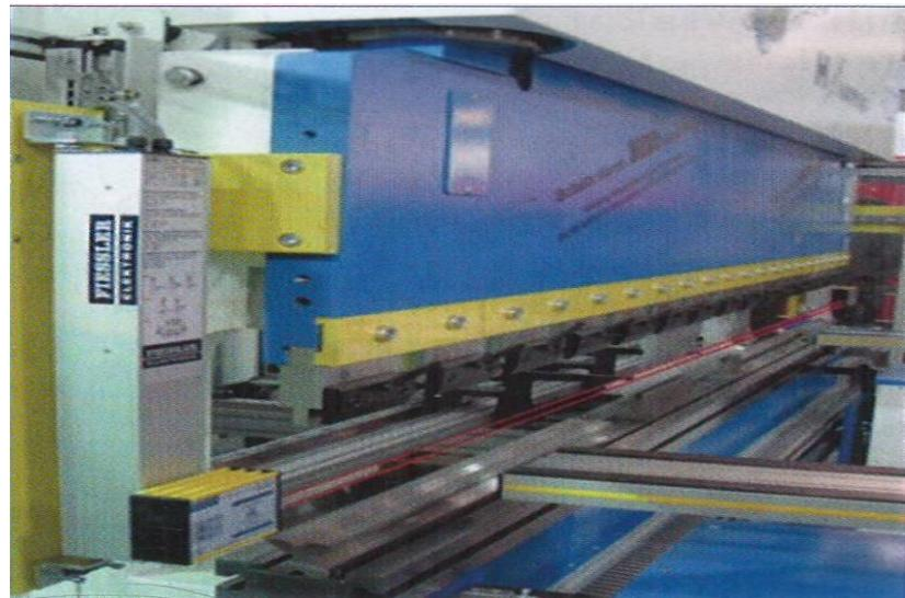
*Slika 6 Laserska zaštita na stroju*
