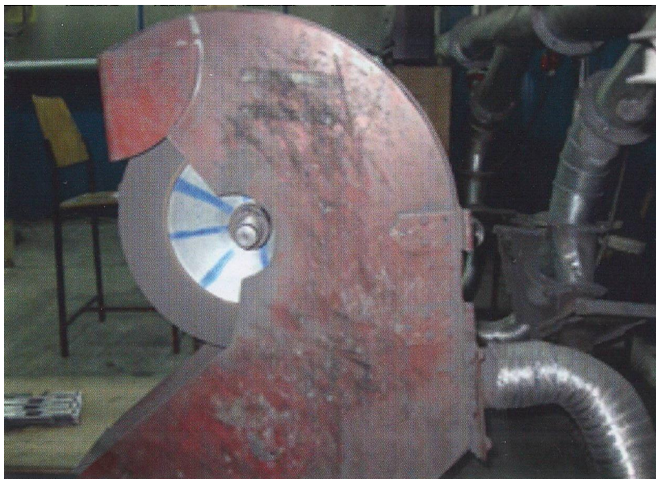
Slika 46 Izgled uređaja za odsisavanje prašine, izrađen u kombinaciji sa zaštitnim oklopom
