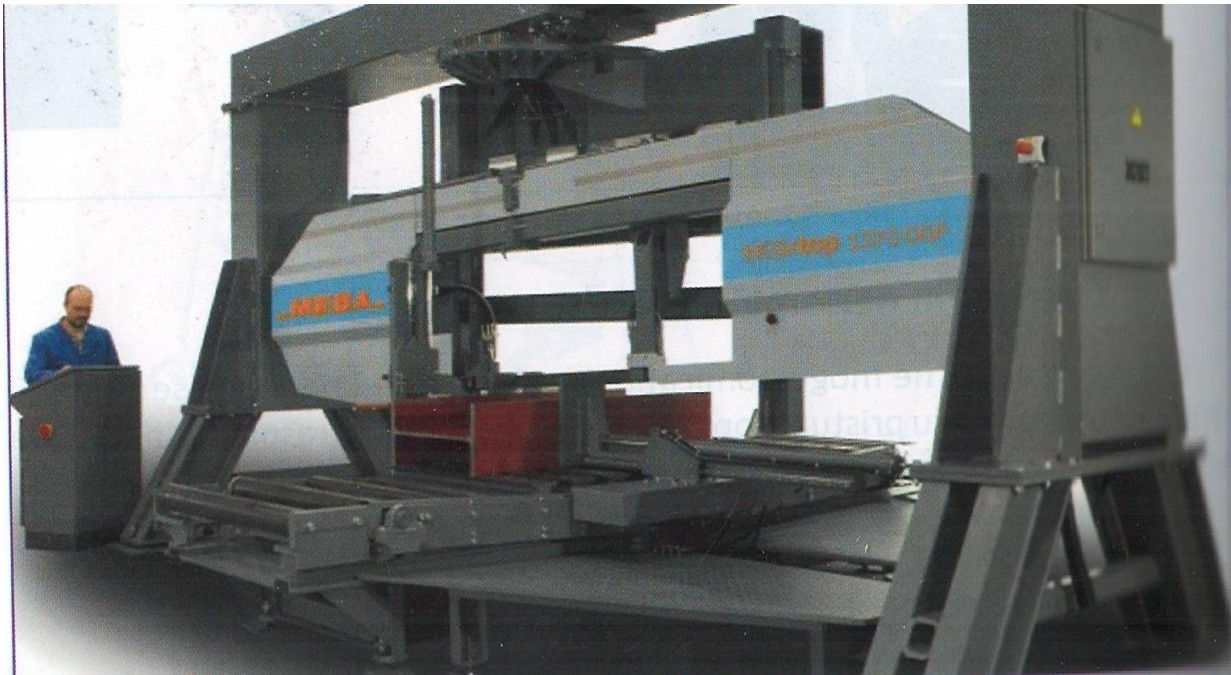
Slika 5 Zaštitna naprava za daljinsko upravljanje
