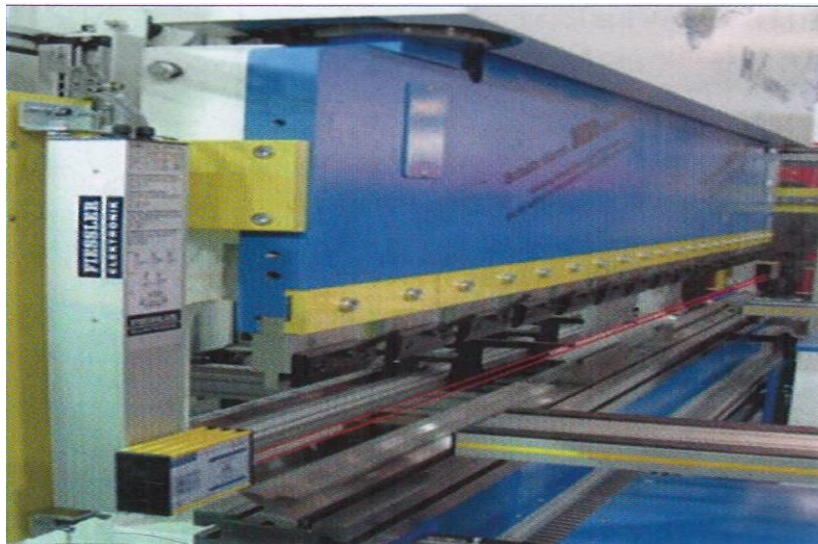
Slika 6 Laserska zaštita na stroju
