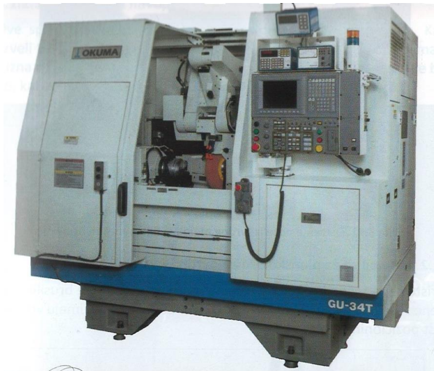
Slika 31 Izgled CNC brusilice za uzdužno vanjsko kružno brušenje
