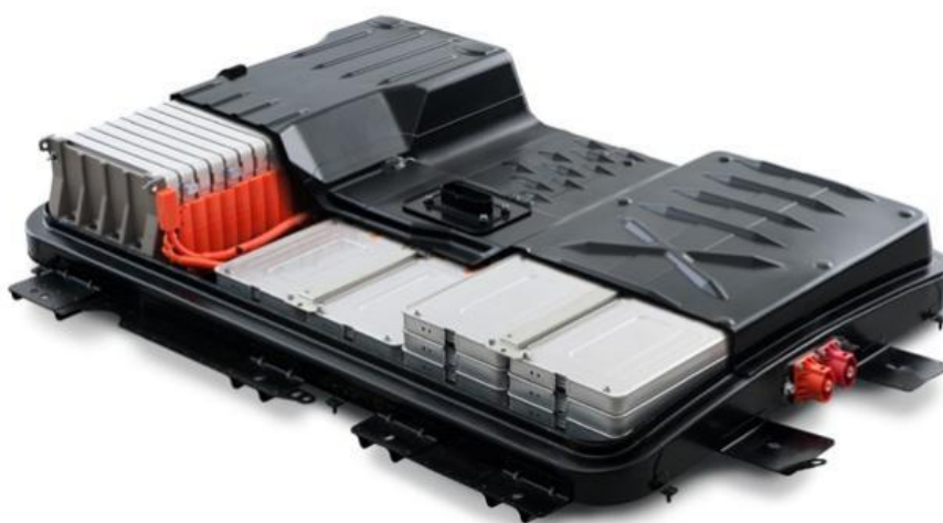
Slika 20. Li-ion baterija u kućištu za lakšu ugradnju
