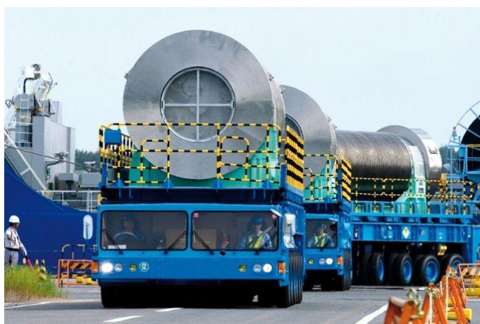
Sl. 16 Transport spremnika istrošenog nuklearnog goriva
