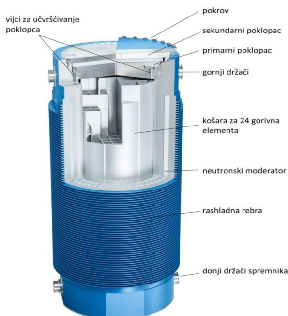
Sl. 5 Spremnik za iskorišteno nuklearno gorivo kod suhog skladištenja
