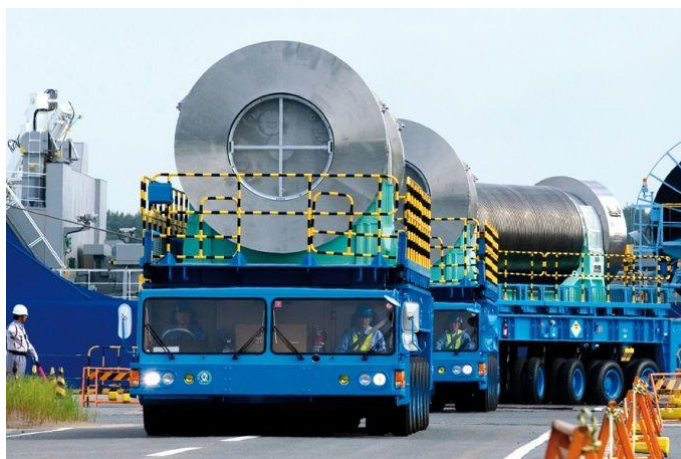
Sl. 16 Transport spremnika istrošenog nuklearnog goriva
