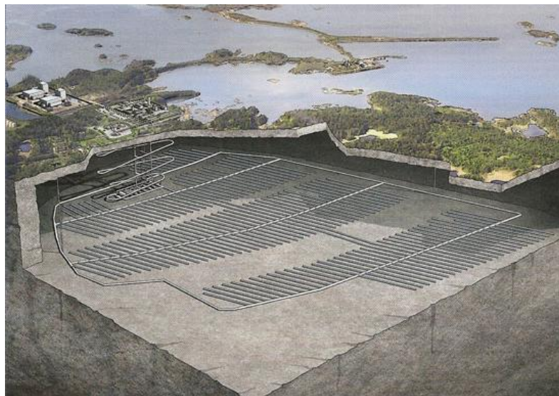
Sl. 22 Shema podzemnog tunelskog tipa odlagališta, Forsmark, Švedska
