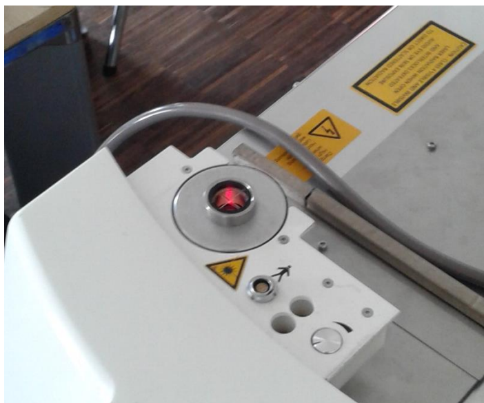
Slika 24. Predožba postolja za testiranje sakupljača zraka sa ciljnikom na izlazu iz lasera
