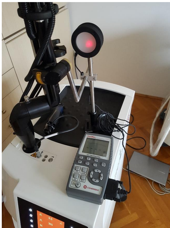
Slika 27. Predložba umjeravanja i mjerenja snaga
