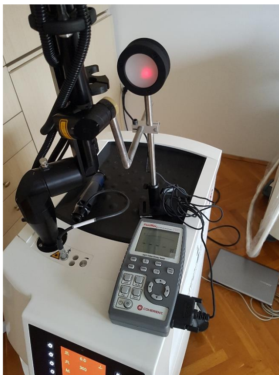
Slika 27. Predložba umjeravanja i mjerenja snaga
