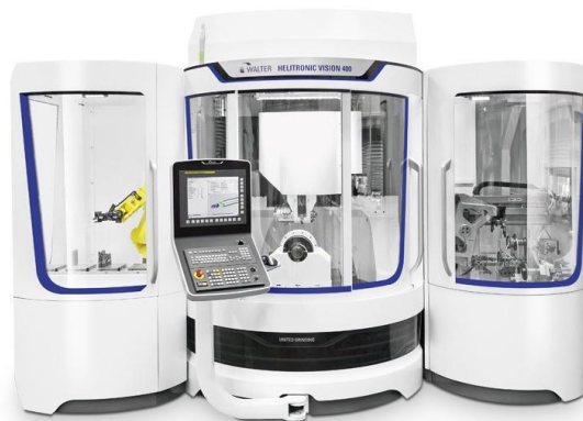
Slika 25. Brusački obradni centar [10]
