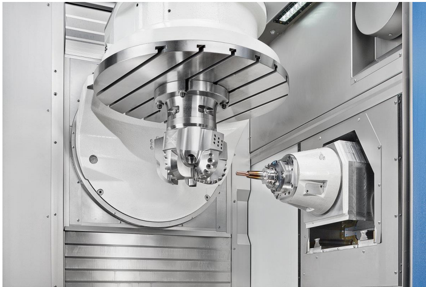
Slika 26. 5x obradni centar [8]
