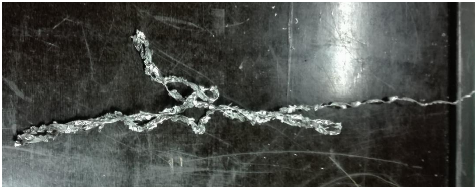
Slika 42. Odvojena čestica nakon 11. provrta
