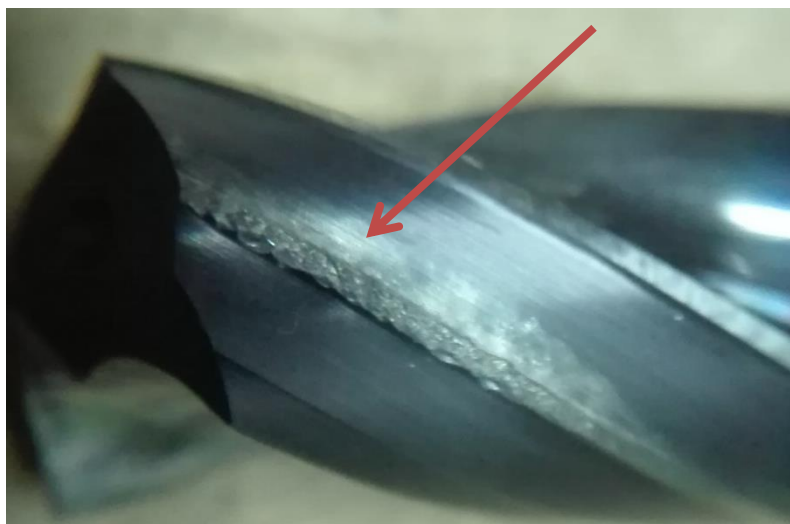
Slika 41. Bočni dio svrdla nakon 11 provrta
