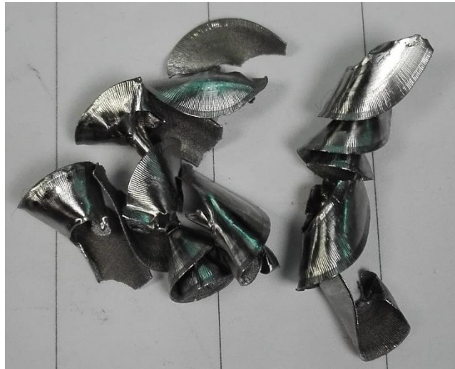
Slika 38. Odvojena čestica prvog provrta
