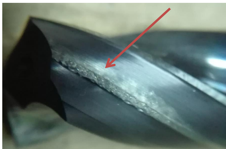
Slika 41. Bočni dio svrdla nakon 11 provrta
