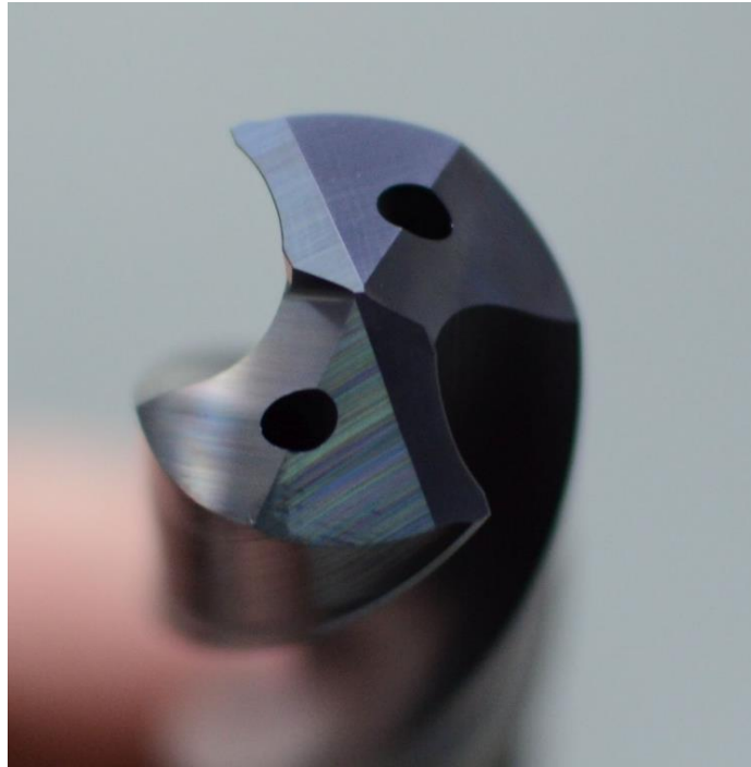
Slika 31. Svrđlo promjera 13 mm
