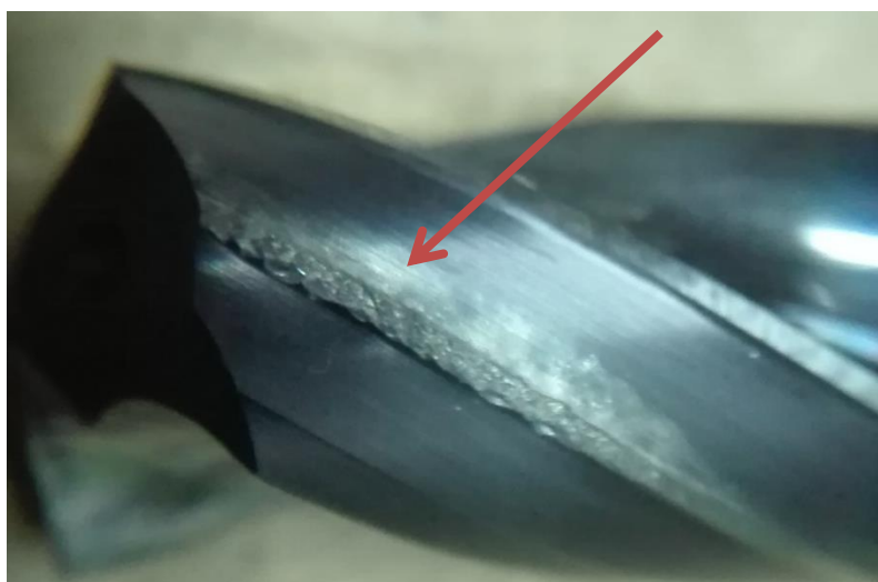
Slika 41. Bočni dio svrdla nakon 11 provrta
