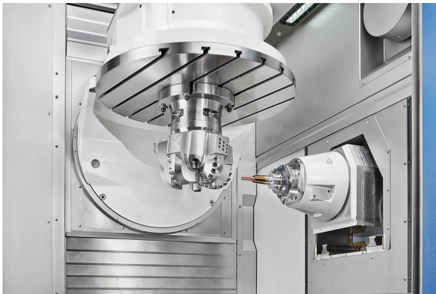
Slika 26. 5x obradni centar [8]
