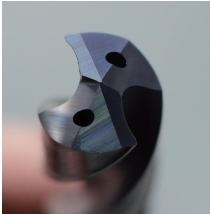
Slika 31. Svrđlo promjera 13 mm
