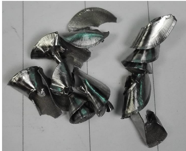
Slika 38. Odvojena čestica prvog provrta
