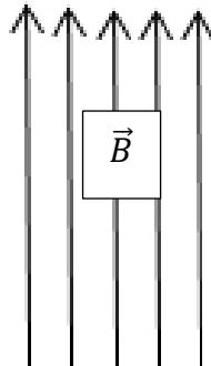
Slika 4. Magnetska indukcija u homogenom magnetskom polju
