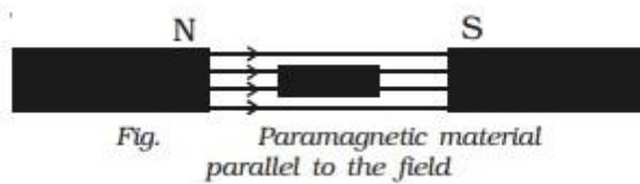
Slika 18. Položaj paramagnetskog materijala u magnetskom polju
