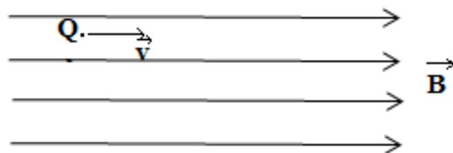
Slika 11. Gibanje naboja paralelno s magnetskim poljem
