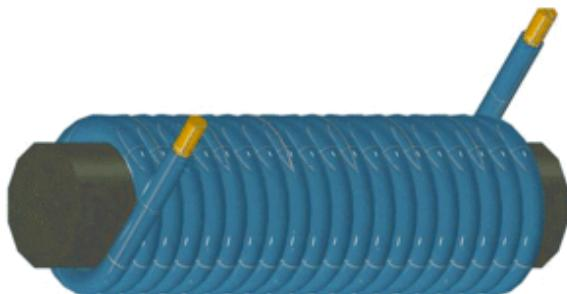
Slika 2. Elektromagnet
