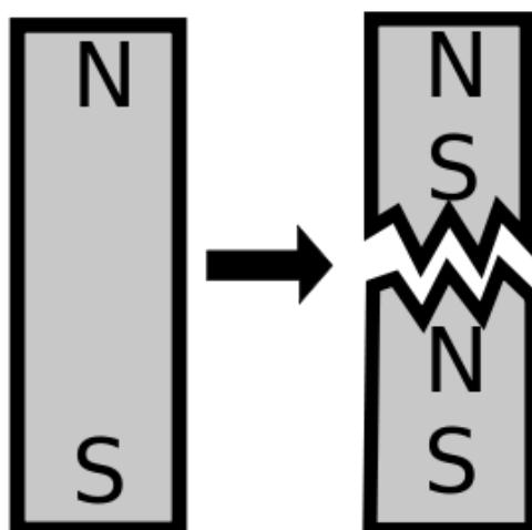
Slika 3. Dijeljenje magneta
