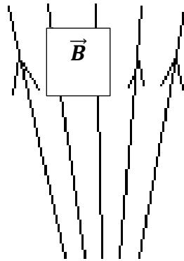
Slika 5. Magnetska indukcija u nehomogenom magnetskom polju
