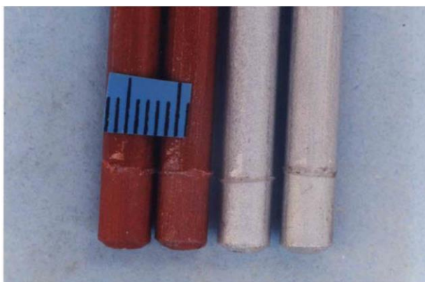
Slika 21. Rutilne elektrode s dvostrukim vodonepropusnim premazom[18]
