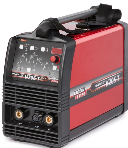
Slika 17. Izvor struje za podvodno zavarivanje [34]
