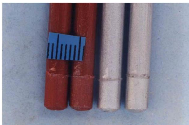
Slika 21. Rutilne elektrode s dvostrukim vodonepropusnim premazom[18]
