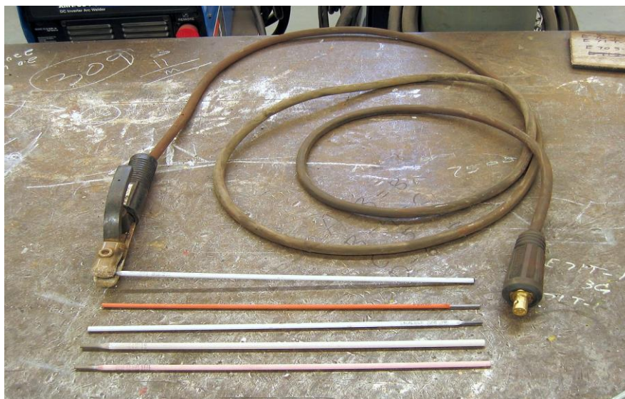
Slika 19. Držać elektrode, zavarivački kabel i obložena elektroda[34]
