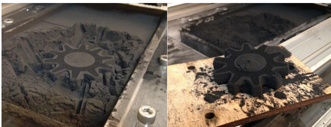
Slika 16. Izradak u spremniku s praškom i izvađeni izradak [50]
