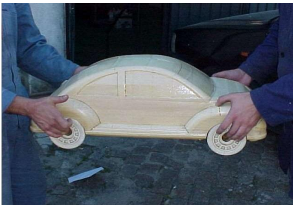
Slika 19. Model auta izrađen LOM tehnologijom [53]
