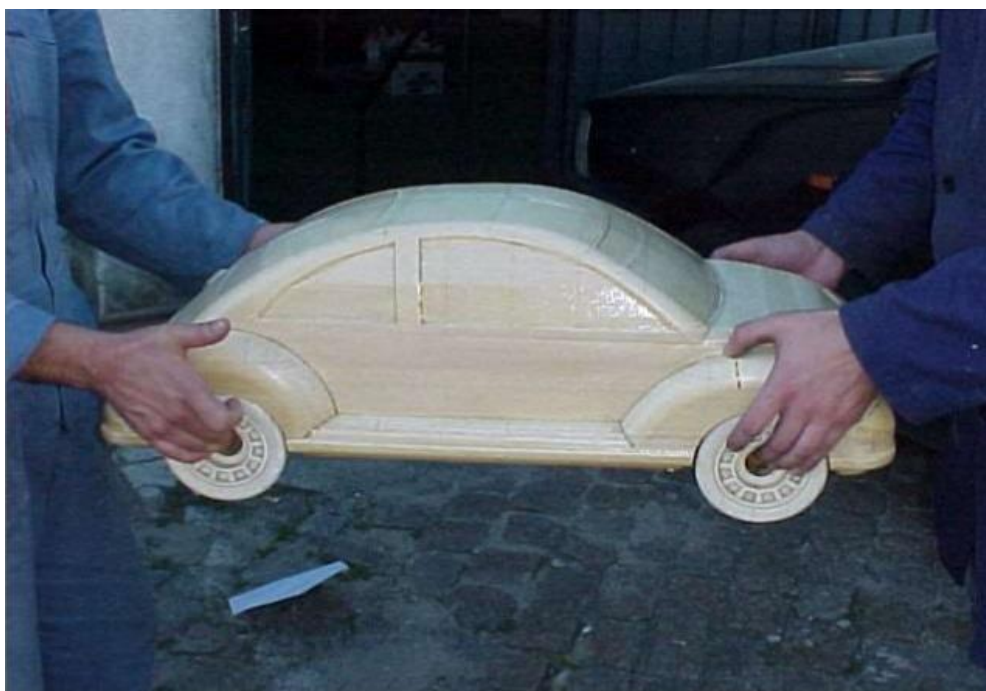
Slika 19. Model auta izrađen LOM tehnologijom [53]
