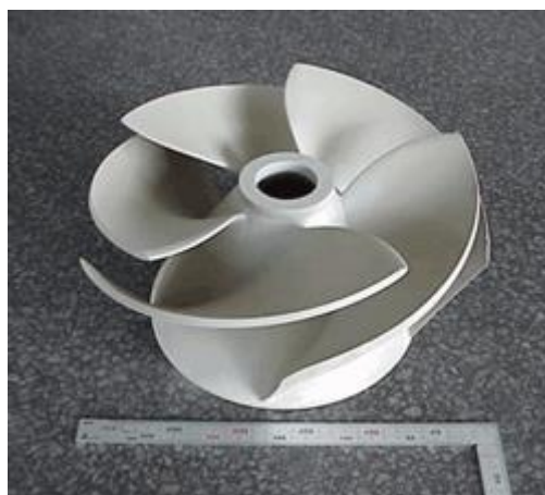
Slika 15. Ventilator izrađen SLS 3D printerom [48]
