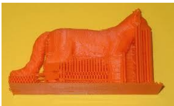
Slika 29. a) Izradak s materijalom za podršku i b) izradak s uklonjenim materijalom za podršku završnom obradom [59]
