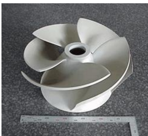
Slika 15. Ventilator izrađen SLS 3D printerom [48]
