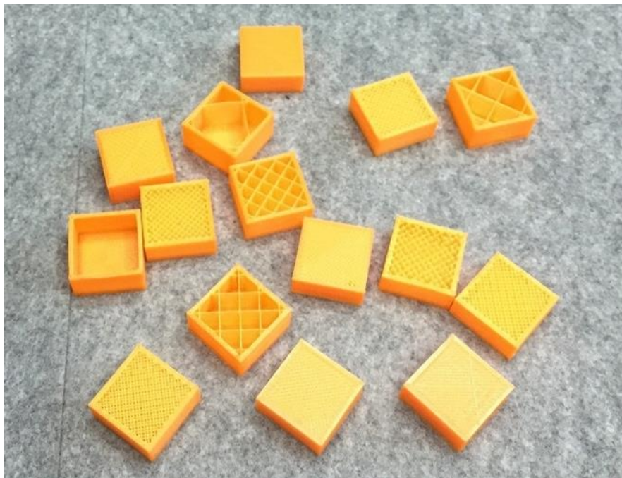
Slika 36. Prikaz različitih vrijednosti ispune kod parametiranja slicing softvera [62]
