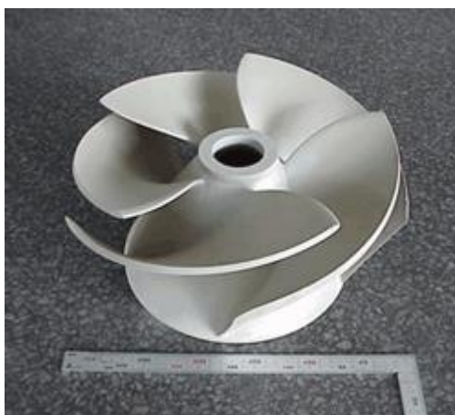
Slika 15. Ventilator izrađen SLS 3D printerom [48]
