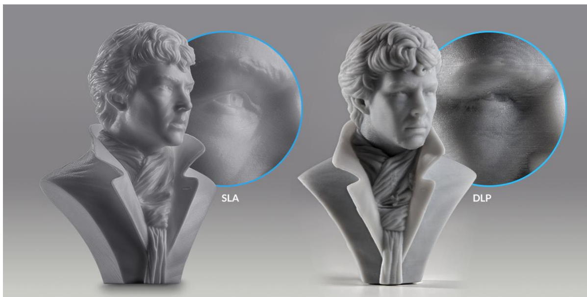
Slika 14. Usporedba kvalitete površine kod SLA i DLP tehnologije 3D printa [47]
