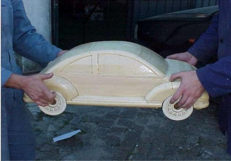
Slika 19. Model auta izrađen LOM tehnologijom [53]
